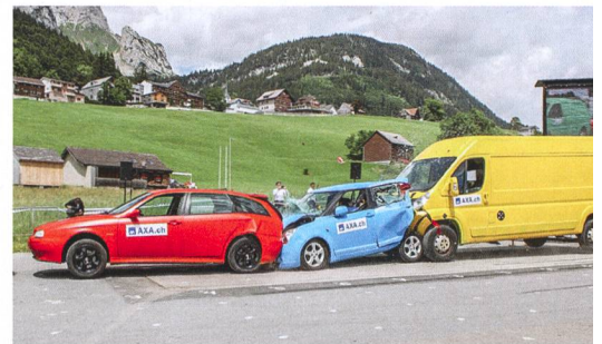
Un véhicule de livraison développe une poussée importante en cas de collision par l'arrière. Qui se trouve au milieu est écrasé.
