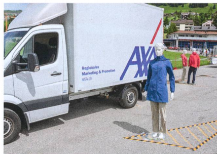
Les véhicules de livraison ont trois angles morts: devant et sur les deux côtés. Le mannequin en montre deux.
