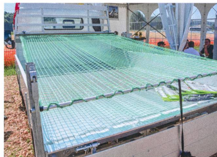
Les charges doivent toujours être fixées dans le véhicule de livraison. Avec ce système, le filet est automatiquement enroulé, mais doit être fixé en plus.
