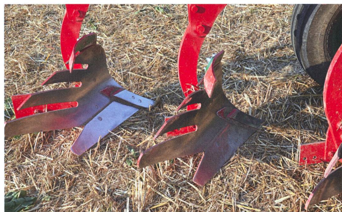
Bien utilisé, le déchaumeur pénètre très peu dans le sol.
