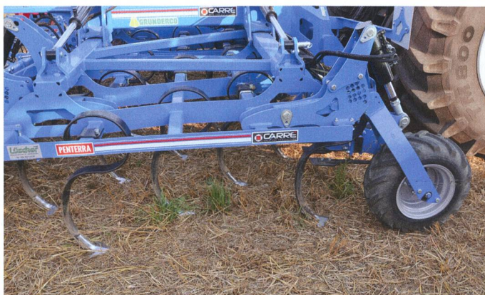
Spécialement conçu pour le travail du sol superficiel: le cultivateur plat de Carré.
