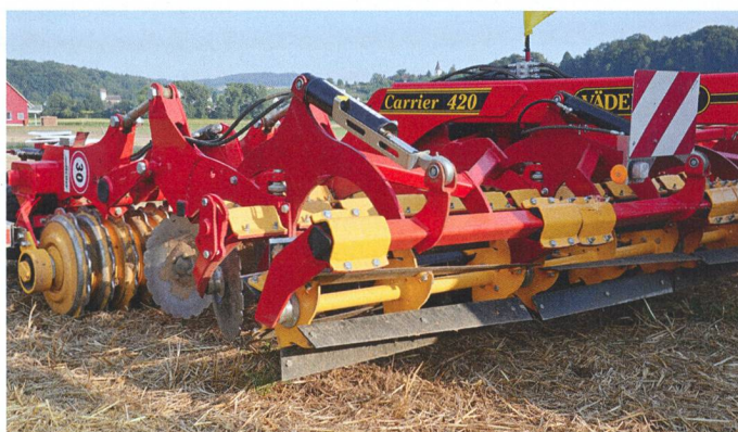
Lorsqu'elle est utilisée pour le travail du sol superficiel, cette herse à disques est précédée d'un cross-cutter.
