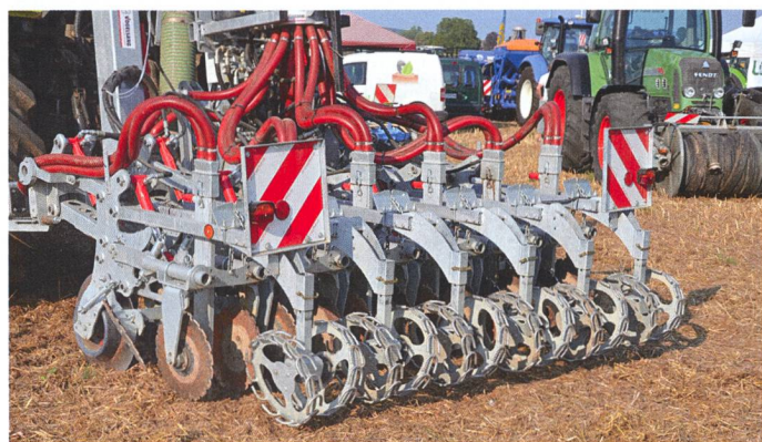
Strip-till monté sur une épandeuse à lisier automotrice.
