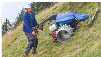
Des crampons garantissent des conditions égales au conducteur et à sa motofaucheuse.
