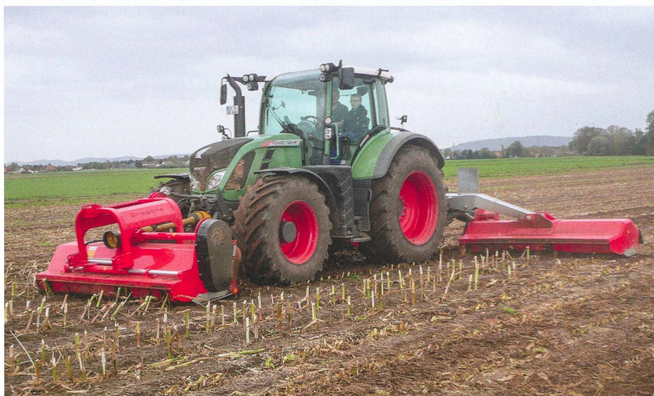
Le montage frontal constitue une bonne solution pour écraser la paille et les chaumes et ne pas les presser contre le sol. (Photo : Ruedi Hunger)
