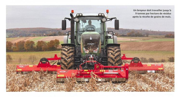
Un broyage intensif des résidus de récolte de silo, de CCM et de maïs grain est obtenu lorsque le broyeur est guidé à une profondeur uniforme, mais sans « travailler » complètement le sol. Le travail du broyeur s'apprécie comme suit:
