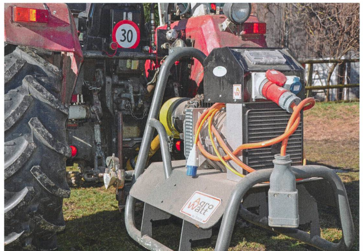
Les câbles et les prises/fiches doivent répondre aux exigences actuelles. Les anciennes prises sont à remplacer.
