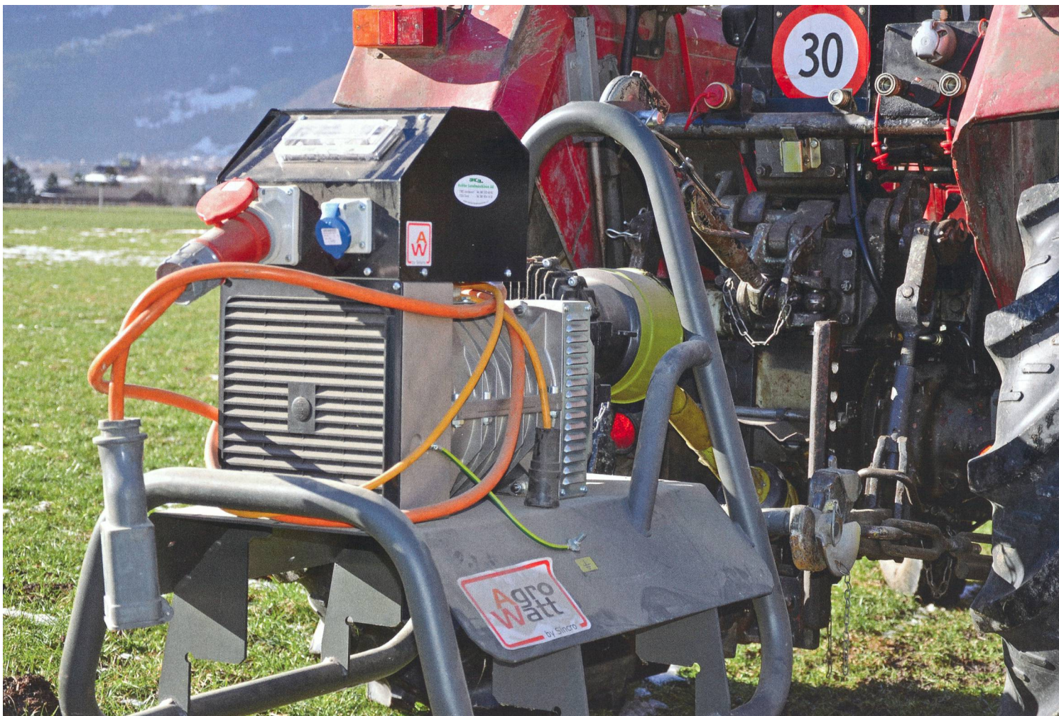
Les génératrices pour attelage trois-points sont performantes et nécessitent que le tracteur ait suffisamment de réserve de puissance. (Photos : Ruedi Hunger)
