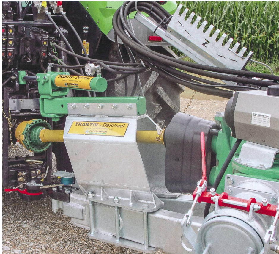
La régulation active limite les situations à risques dans les courbes et répartit la charge au niveau du tracteur. (Photo : Zunhammer)
