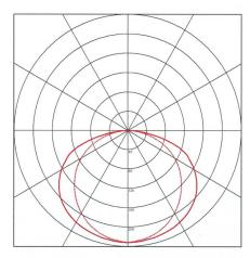
Répartition de la lumière par une lampe TL équipée de réflecteurs (trait continu = ligne transversale à l'axe longitudinal, trait en pointillé = ligne parallèle à l'axe longitudinal). Sans réflecteur, près de la moitié du flux lumineux serait projeté sur le plafond, sans réelle utilité. Grâce à un réflecteur de qualité, près de 90 % du flux lumineux est redirigé dans la bonne direction. (Source de l'illustration Tulux)
