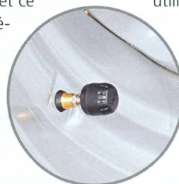
Des transpondeurs sur les roues peuvent transmettre la pression au terminal dans la cabine par l'antenne située sur le tracteur.
