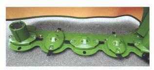
Cette classe d'appareils bénéficie désormais en série aussi d'un dispositif de fixation rapide des lames à l'aide d'un outil fourni avec la machine.
