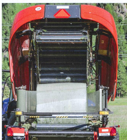
Une fois le liage par feuille effectué, la chambre de presse s'ouvre pour procéder à l'enrubannage.
