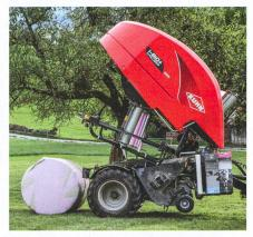
Le système d'enrubannage «IntelliWrapTM» possède deux dispositifs tendeurs qui tournent autour de la balle à raison de 50tr/min.
