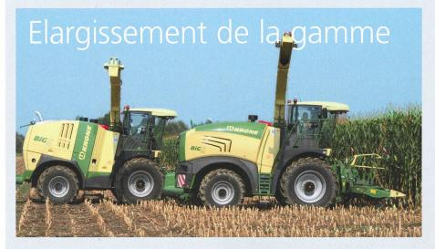
Krone met sur le marché trois nouvelles ensileuses du type «Big X», avec des canaux d'alimentation de 800 mm pour l'une et de 630 mm pour les deux autres. Elles sont dotées d'un moteur de respectivement 753 ch, 530 ch et 626 ch.
