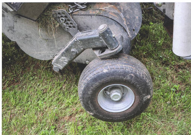
En option, le pick-up peut être équipé de roues de jauge pivotantes.
