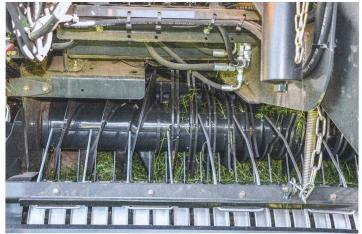
Vue du rotor monobloc, équipé de deux vis sans fin à trois spires de part et d'autre pour amener le fourrage au centre.
