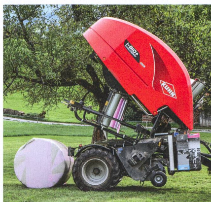
Le système d'enrubannage « IntelliWrap™ » possède deux dispositifs tendeurs qui tournent autour de la balle à raison de 50tr/min.
