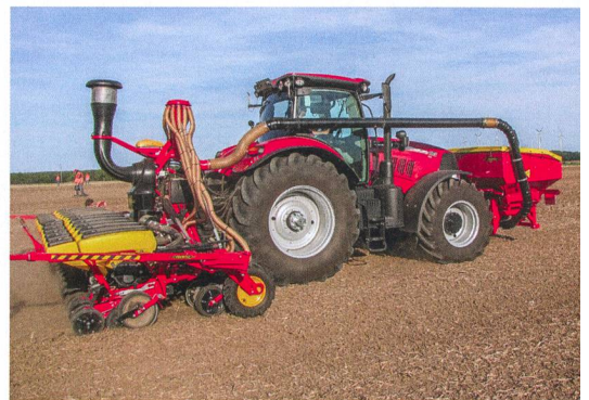
Aspiration surélevée auprès du semoir «Tempo V» attelé au trois points.
