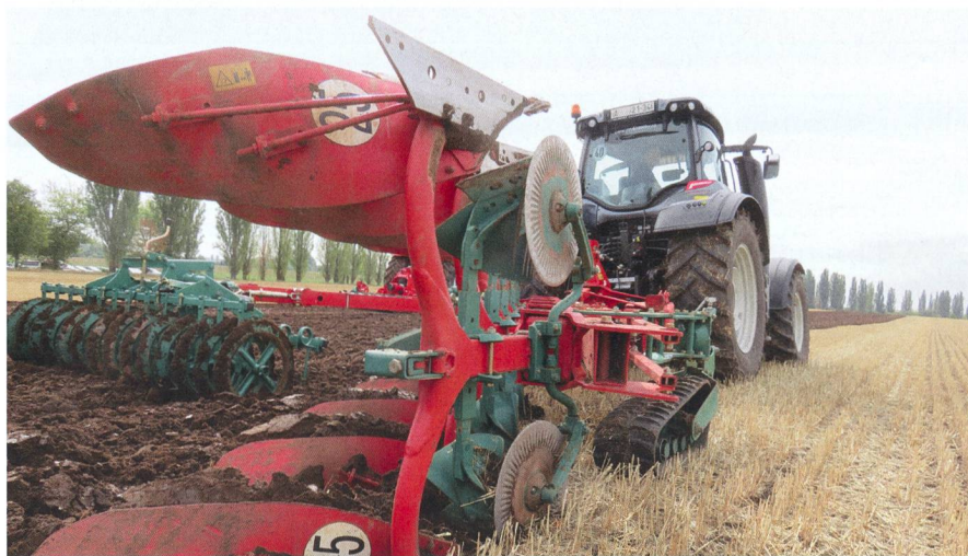
Avec sa nouvelle série de charrues « 2500 », Kverneland vise le segment, en croissance, des 5-6 socs. Plus respectueuse de l'état du sol, la chenille de ce modèle est proposée comme alternative à la traditionnelle roue d'appui. (Photos : Roman Engeler)
