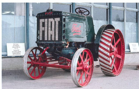
Le premier tracteur Fiat de 1919 équipé d'un moteur à pétrole de 6235 cm 3 .
