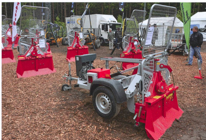
Remorques pour voitures avec grue forestière (en haut) ou avec treuil (en bas). Souvent pour le petit propriétaire de forêt, moins c'est plus. Il cherche aussi des solutions pour travailler ergonomiquement.
