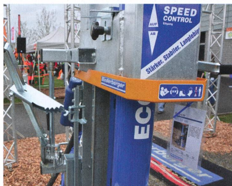
Commande à griffe: Binderberger mise sur la commande bimanuelle à griffe qui a fait ses preuves.
