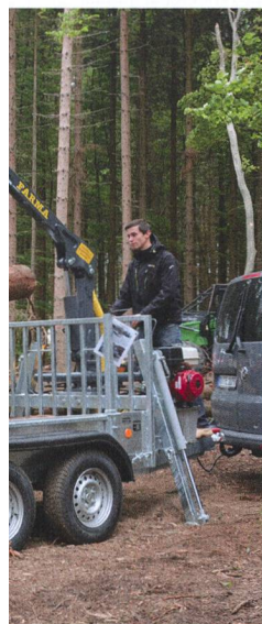
Remorques pour voitures avec grue forestière (en haut) ou avec treuil (en bas). Souvent pour le petit propriétaire de forêt, moins c'est plus. Il cherche aussi des solutions pour travailler ergonomiquement.
