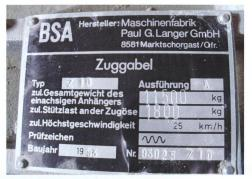
Cette plaquette-constructeur fixée à la chape indique le poids remorquable et la charge d'appui admissible pour une vitesse donnée.
