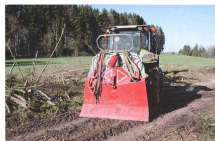
Treuil à traction constante et à déroulement du câble contrôlé, à l'exemple de Taifun.
