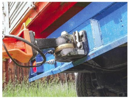
Grâce à un châssis renforcé et à une boule d'attelage «K80», ce train routier est particulièrement sûr. (Photos: Ruedi Hunger)
