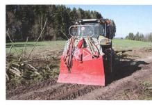
Treuil à traction constante et à déroulement du câble contrôlé, à l'exemple de Tajfun.
