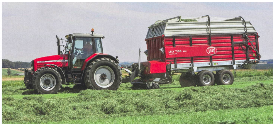
Le fourrage doit rester aéré lorsqu'on le charge pour l'engranger. Pour ce faire, il vaut mieux utiliser une autochargeuse généreusement dimensionnée et faire des andains réguliers.
