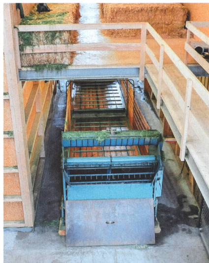
Pour être bien détaché et réparti de façon aérée, le fourrage très humide passe par un doseur.
