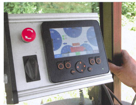
Le moniteur avec cinq champs d'affichage et des lampes témoins offre une excellente vue d'ensemble sur les paramètres du système.
