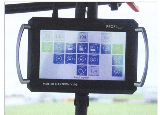
L'écran tactile 7" affiche tous les paramètres opérationnels des divers composants de l'installation et du dispositif de pompage et permet de contrôler et de régler l'équipement à distance.
