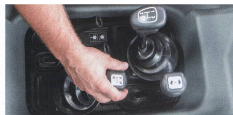
Lorsqu'on veut travailler en mode hydrostatique, on doit enclencher le levier manuel de mode sur la position « H » et choisir ensuite l'une des huit plages de vitesse.
