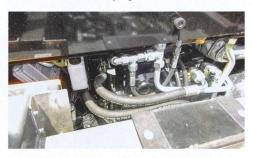
Les composants hydrostatiques sont positionnés latéralement au carter de la transmission. A gauche, le moteur hydraulique, et à droite, la pompe hydraulique.
