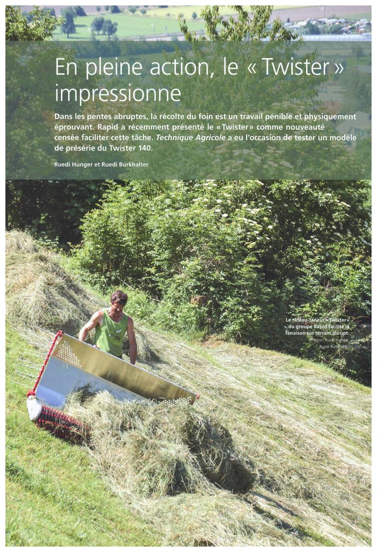
Le mot *twist* vient de l'anglais et signifie « rotation ». La notion de rotation reflète parfaitement le fonctionnement « Twister », un outil pour motofaucheuses et porte-outils agricoles motorisés monoaxes permettant de récolter le foins et spécialement développé pour travailler sur les terrains pentus. Une présérie de 80 appareils est actuellement présentée par les partenaires commerciaux, avec des démonstrations en situation réelle.
