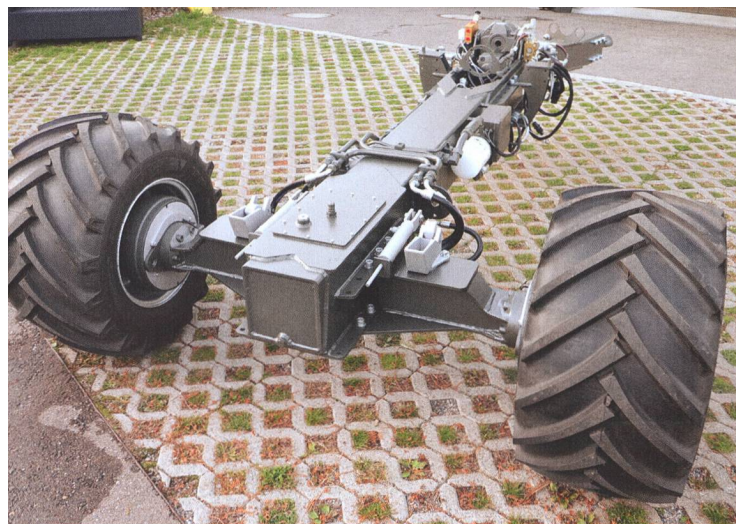
Le châssis tubulaire effilé à réservoir d'huile intégré permet d'abaisser le centre de gravité et de multiplier les possibilités de fixer des équipements.
