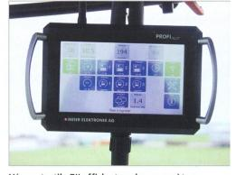
L'écran tactile 7" affiche tous les paramètres opérationnels des divers composants de l'installation et du dispositif de pompage et permet de contrôler et de régler l'équipent à distance.
