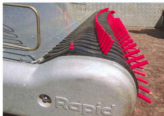
La disposition ondulée des dents permet de favoriser le glissement du foin. Cette vue met clairement en évidence la forme particulière de la tringle de débouillage noire.
