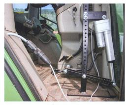
Un servomoteur capte le signal lui ordonnant de modifier la vitesse de rotation de la prise de force par l'intermédiaire de la pédale d'accélérateur.
