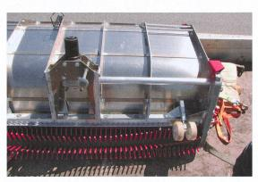
Le pick-up est entraîné par une transmission mécanique. Les roulettes jumelées peuvent être facilement ajustées grâce aux goupilles.
