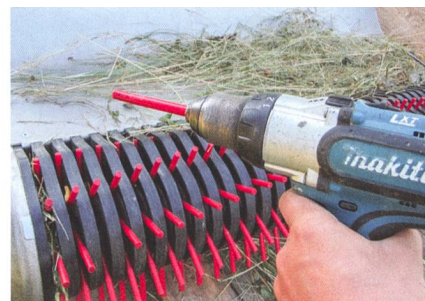
Les dents souples sans filetage usiné peuvent être simplement vissées dans le filetage rigide du cylindre.
