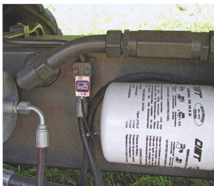
Sur les machines de série, l'inclinomètre (au centre) et la plupart des autres composants seront intégrés à l'intérieur du châssis.
