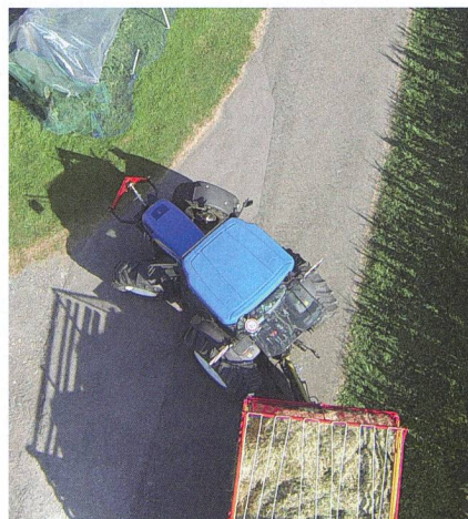
Le timon orientable permet de «tourner très serré» sans que la remorque ne touche les roues du tracteur.
