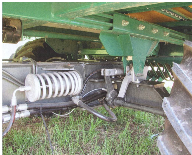
A côté des points d'attache, on distingue ici le cylindre du frein de service et le frein à ressort à accumulation (à g.).
