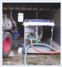
Rendement maximal, grâce à une pompe à piston électrique réversible. (Photo: idd)
