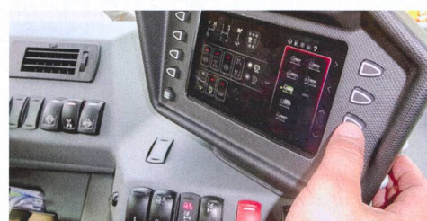
Reform a développé un concept d'application pour faciliter la tâche du conducteur. Un terminal lui donne un choix de sept types de réglages pour travailler de manière optimale (ici le type pour le travail avec l'autochargeuse).
