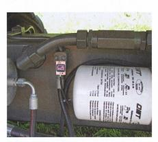
Sur les machines de série, l'inclinomètre (au centre) et la plupart des autres composants seront intégrés à l'intérieur du châssis.
