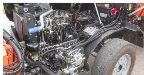
Grâce à la cabine basculante, l'accès aux contrôles d'entretien est largement facilité.
