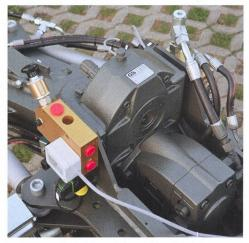
A l'avant du châssis, l'unité de pompage avec l'axe de prise de force pour les équipements intégré.
