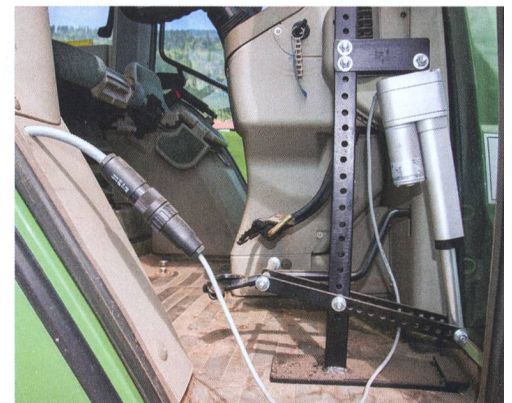
Un servomoteur capte le signal lui ordonnant de modifier la vitesse de rotation de la prise de force par l'intermédiaire de la pédale d'accélérateur.
