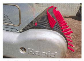
La disposition ondulée des dents permet de favoriser le glissement du foin. Cette vue met clairement en évidence la forme particulière de la tringle de débourrage noire.
