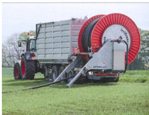
Le chassis 3 essieux assemblant le réservoir tampon avec ses unités hydrauliques, les pompes et la «Black Box ProfiPilot», ainsi que le tuyau d'approvisionnement en lisier.
