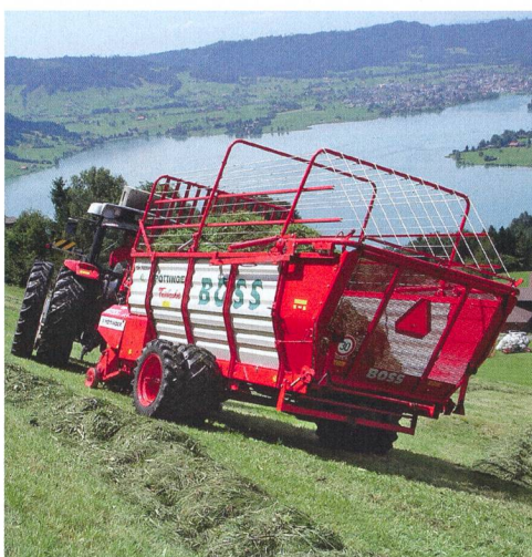
La conduite dans les pentes impose des contraintes importantes au châssis, ainsi qu'aux pneumatiques. (Photo: Konrad Merk)
