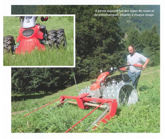
faucheuses. Par rapport au tracteur ou à la faucheuse à deux essieux, celui-ci s'avère imbattable dans les zones humides et marécageuses, où l'environnement est particulièrement sensible.
