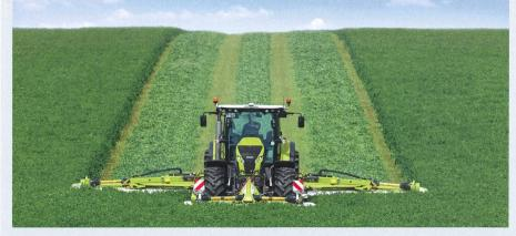
Claas s'apprête à commercialiser la faucheuse combinée à conditionneur la plus large du marché. La faucheuse à disques « Disco 1100 Business » atteint en effet la largeur de travail maximale de 10,70 m. Claas aborde la saison 2016 avec neuf nouvelles faucheuses attelées avant et arrière couvrant entre 2,60 m et 3,40 m de largeur de travail tout en installant le nouveau lamier « Max Cut » sur la plupart des modèles « Disco ». (Photo: Claas)
