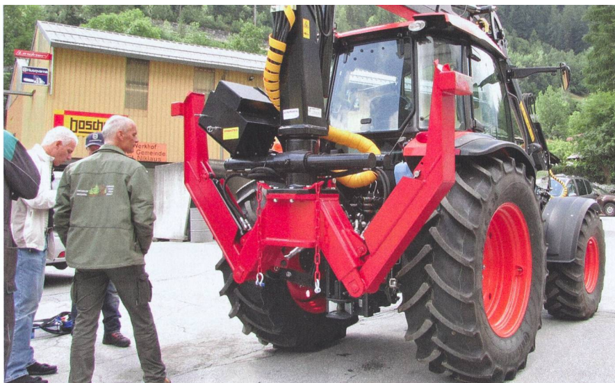
Ad. Bachmann AG présente un tracteur Kubota équipé de la grue forestière rigide de Farmi, montée sur trois-points.
