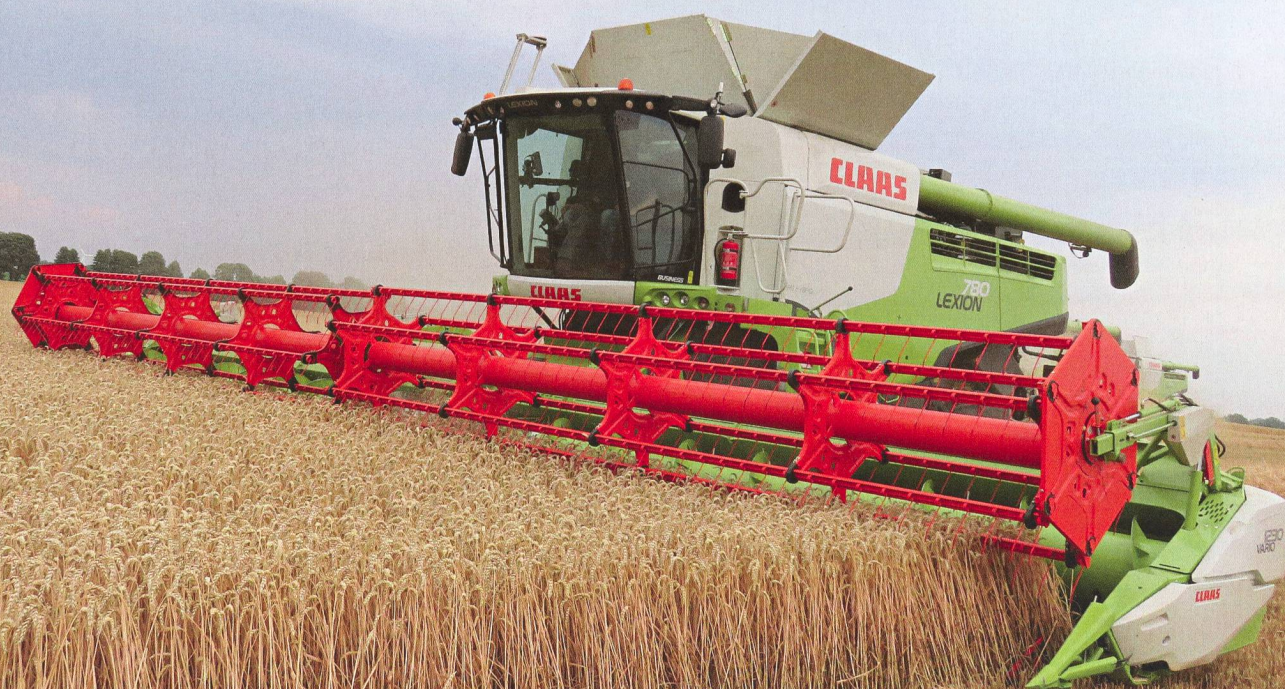
La « Lexion 780 », fleuron des moissonneuses-batteuses Claas, est équipée d'un moteur neuf et d'une plus grande trémie. (Photo : Roman Engeler)
