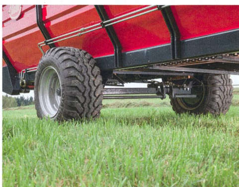
Un châssis abaissé jusqu'au niveau de l'essieu garantit un centre de gravité bas et une meilleure stabilité dans les pentes. (Photo: Vicon)
