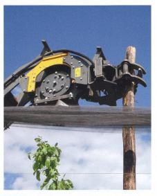
Sylvain Pasche a démontré avec son trax de six tonnes comment il plante un piquet mesurant plus de 4m de haut et 14 cm de diamètre. Placé sur le sol, à côté de l'emplacement souhaité, le piquet
