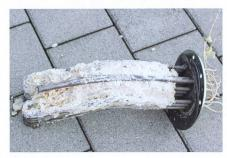
Corps de chauffe fortement entartré: il vaudrait mieux détartrer plus tôt, car l'épaisse couche de calcaire endommage la conduction de chaleur. Cette dernière monte davantage dans le tuyau supérieur contenant les capteurs de température qu'en l'absence de calcaire, ce qui conduit à des erreurs de mesure. Si le tartre devient trop important, le thermostat de sécurité du corps de chauffe se déclenche et provoque l'arrêt du boiler.
