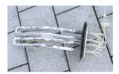
Corps de chauffe détartré: un détartrage «foudroyant» avec un produit chimique n'est pas indispensable. Veiller à ne pas endommager le corps de chauffe en détartrant manuellement avec une spatule.
