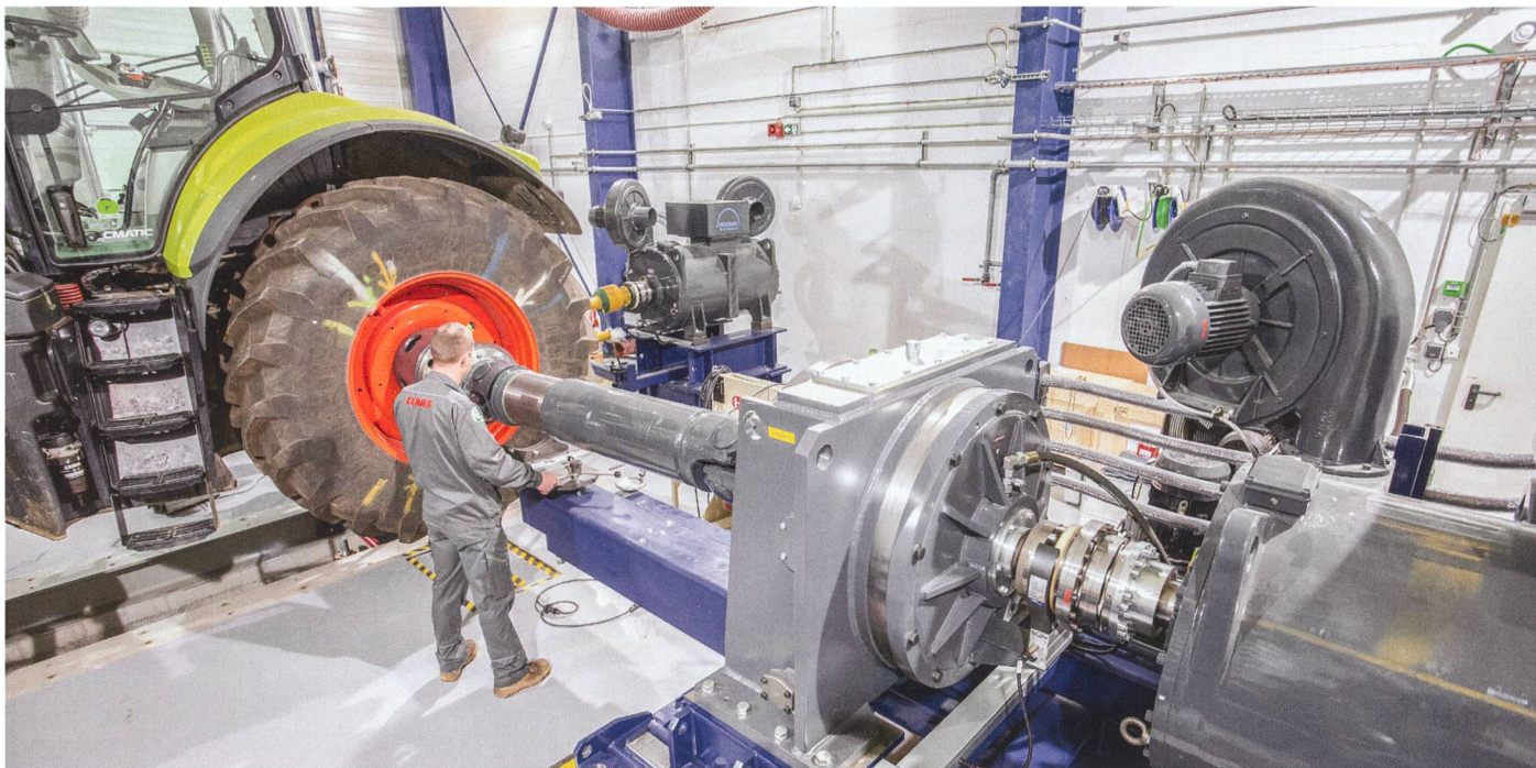
Le nouveau banc d'essais de «Roulage» est destiné aux tracteurs Claas, de l'Axos au Xerion. Il permet de réaliser des tests de résistance aux contraintes avec une puissance totale de 2500 kW. (Photos d'usine)
