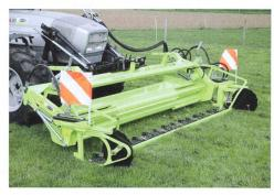
Le faible besoin en puissance et le poids léger constituent les atouts des faucheuses à barre de coupe. Ce modèle est également équipé d'un conditionneur.
