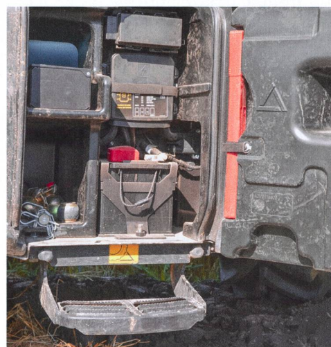
Dans le coffre verrouillable par clé, batterie, fusibles, outils et espace de rangement.
