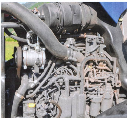
Le moteur AGCO Power suralimenté tire 121 kW (avec suralimentation 132 kW) de sa cylindrée de 6,6 litres. Sa technologie SCR lui permet de remplir les normes antipollution actuelles.
