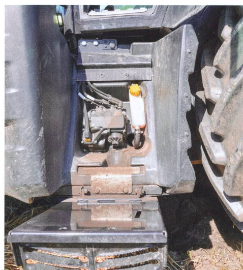
Protégée derrière l'escalier rabattable, la goulotte de remplissage de l'huile hydraulique.
