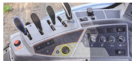
Dans la cabine, la «section hydraulique» est aussi clairement ordonnée. Quatre vannes de commande dont une avec réglage du débit d'huile.
