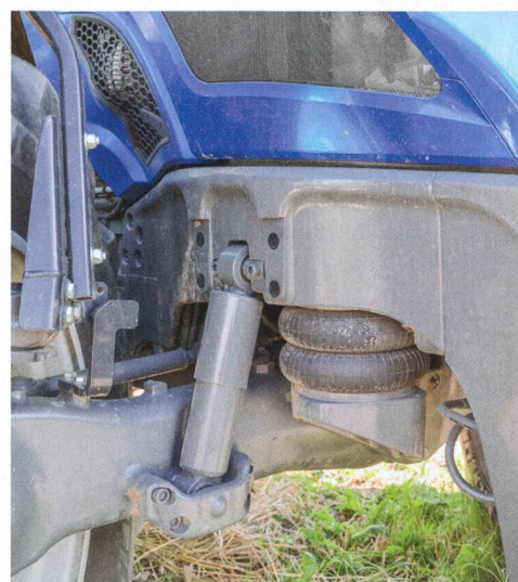
Argument publicitaire unique des tracteurs Valtra, le pont avant suspendu pneumatique avec technologie « Aires+ ».
