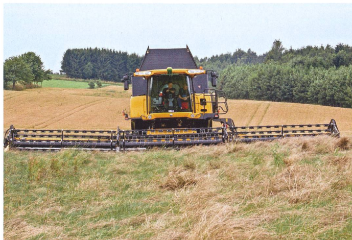
Une barre de coupe en trois sections, très large et s'adaptant bien aux inégalités du terrain. (Photo: Geringhoff-TriFlex-1013)
