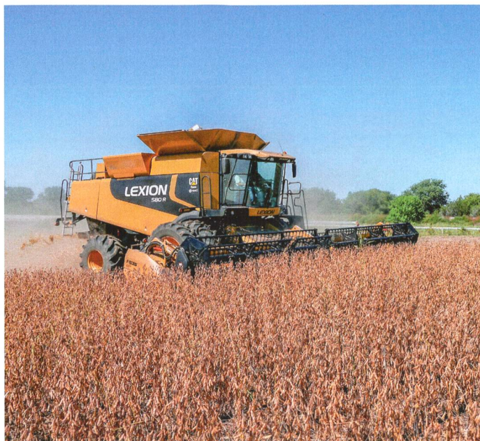
Le soja émet des gousses tout près du sol; sa récolte exige une barre de coupe qui suive la surface de très près. (Photo : CAT-Lexion-Sojadrusch)
