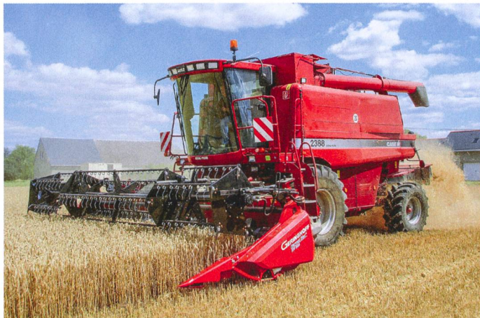
La barre pliable Geringhoff Harvest-Star possède un système d'accouplement bien abouti. (Photo : Geringhoff-Harvest-Star-878)
