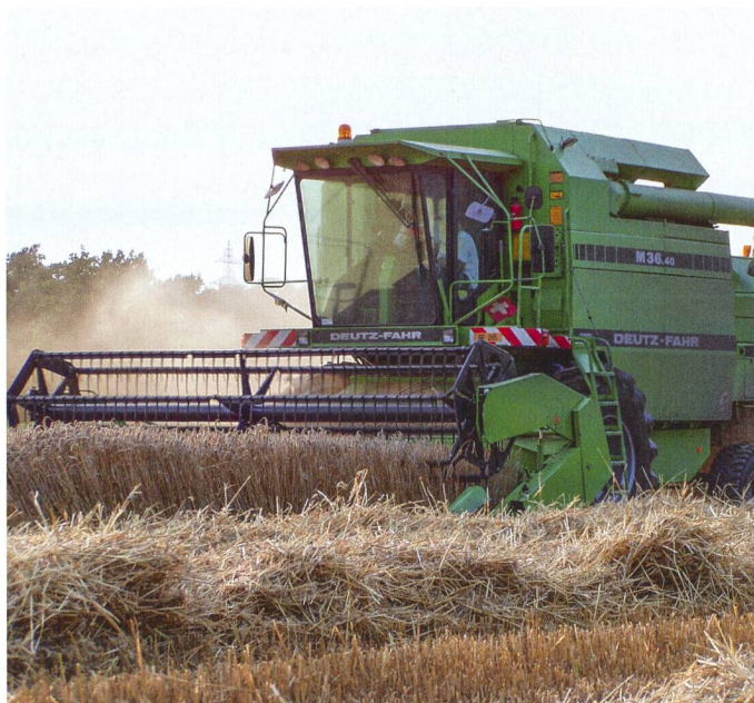
Une barre universelle permet de récolter toutes les céréales. Equipée et adaptée en conséquence, elle moissonne du colza. (Photo : Ruedi Hunger)
