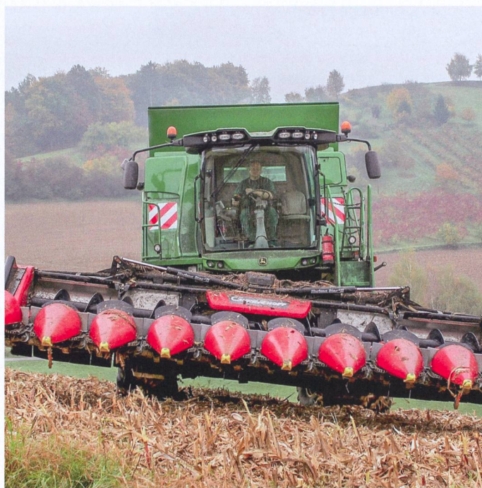
La diversité des barres de coupe est aussi en fonction de la diversité des productions à récolter. Ici une moissonneuse-batteuse avec barre à maïs. (Photo : Mais-Star-Horizon)
