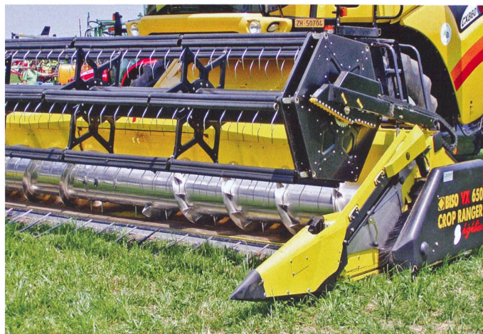
La BISO VX Crop Ranger est une barre vario avec une amplitude de réglage de 70 cm. (Photo: Ruedi Hunger)
