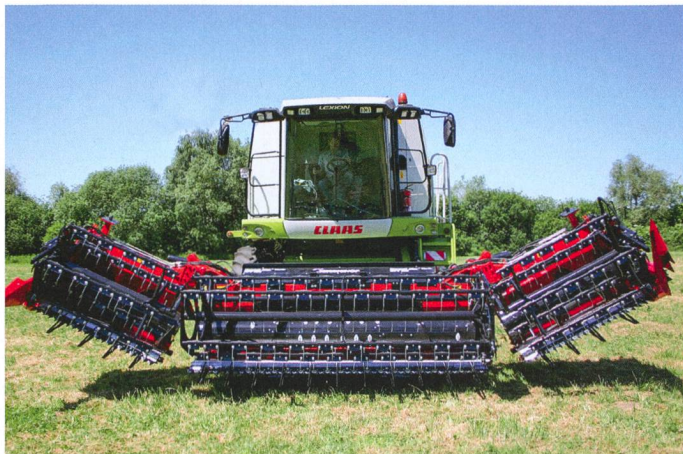
La présence d'une table à longueur variable complexifie encore le mécanisme de pliage des barres de coupe. (Photo : Harvest-Star-Vario)
