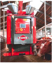
positionné dans l'axe d'affourragement et se distingue par sa grande simplicité: un rotor de distribution de grande dimension coupe, mélange et répartit le fourrage en un seul passage. L'ajout de concentrés se fait au moyen d'une trémie placée directement sur le Feed Robot KUHN au cours de la même phase de distribution
