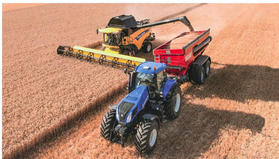
Le transbordement continu relié avec la commande automatisée du remplissage de la remorque fait partie d'une chaîne de processus efficace. (NH-CX-8090-Elevation-Werkfoto)
