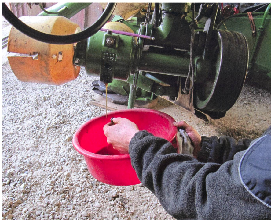
La vidange des carters et du lamier s'effectue selon les instructions du manuel d'utilisation.
