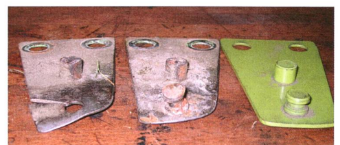
Utiliser des porte-lames usés à ce point est de la négligence pure. A droite, un porte-lame neuf.
