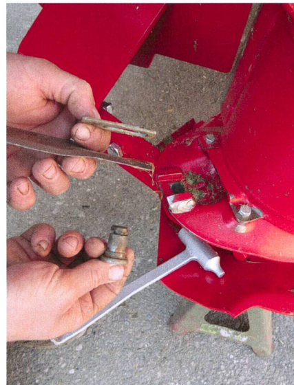
Les fixations rapides facilitent le changement des lames et la maintenance de la faucheuse.
