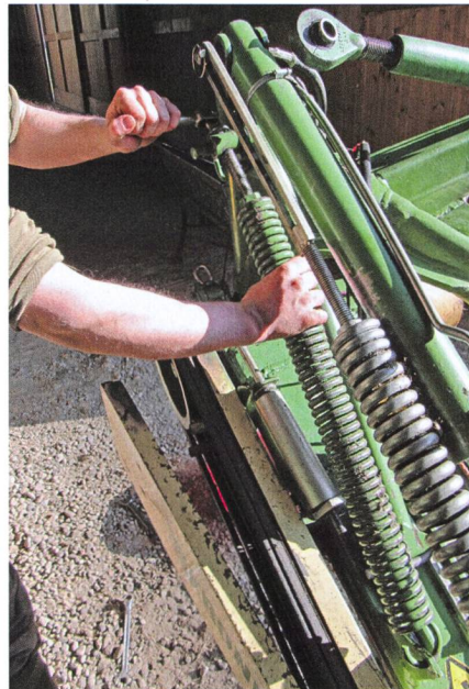
Contrôle du fonctionnement et de l'état des ressorts du système de délestage.
