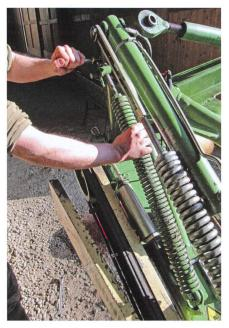
Contrôle du fonctionnement et de l'état des ressorts du système de délestage.
