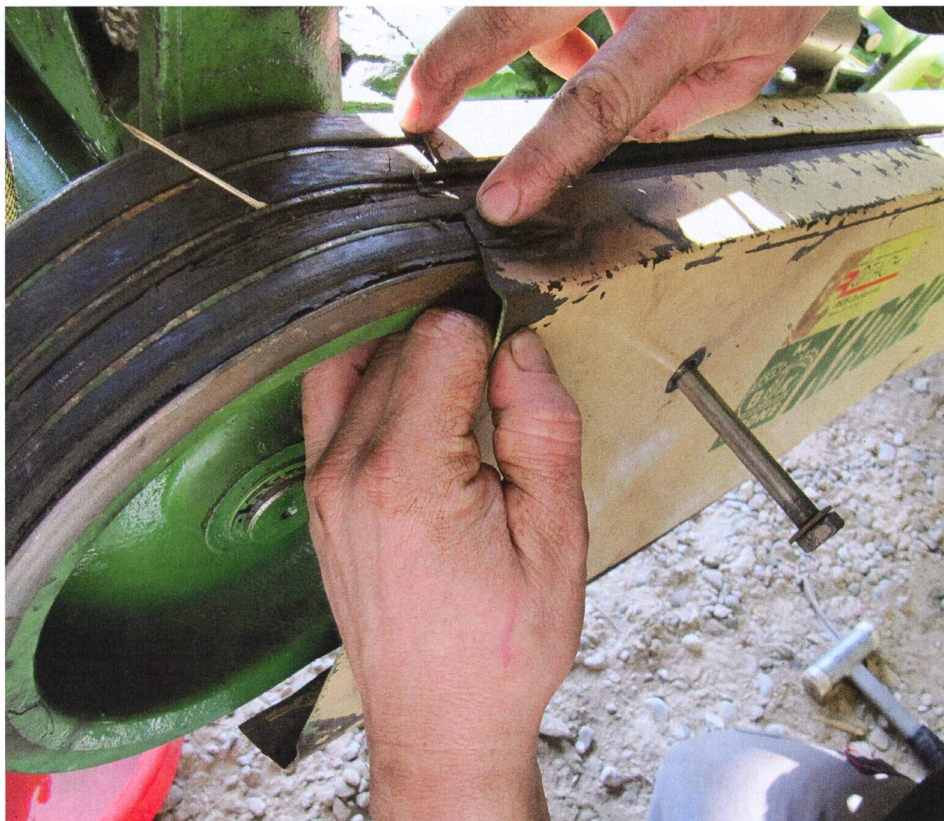
Une courroie un peu abîmée peut encore tenir quelque temps. Mais il est bon d'en avoir en réserve sous la main.
