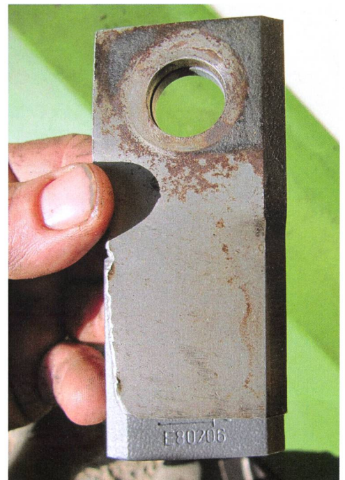
Attention ! Les copies de lames doivent être parfaitement conformes. Vérifier que leurs dimensions et le diamètre du trou soient exacts : ça se voit à l'œil nu en superposant deux lames comme ici. Ne monter que des pièces homologuées.
