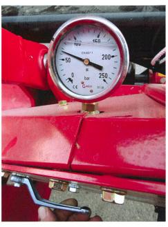
Le réservoir du système de délestage hydraulique doit être contrôlé par un professionnel à peu près tous les huit ans.
