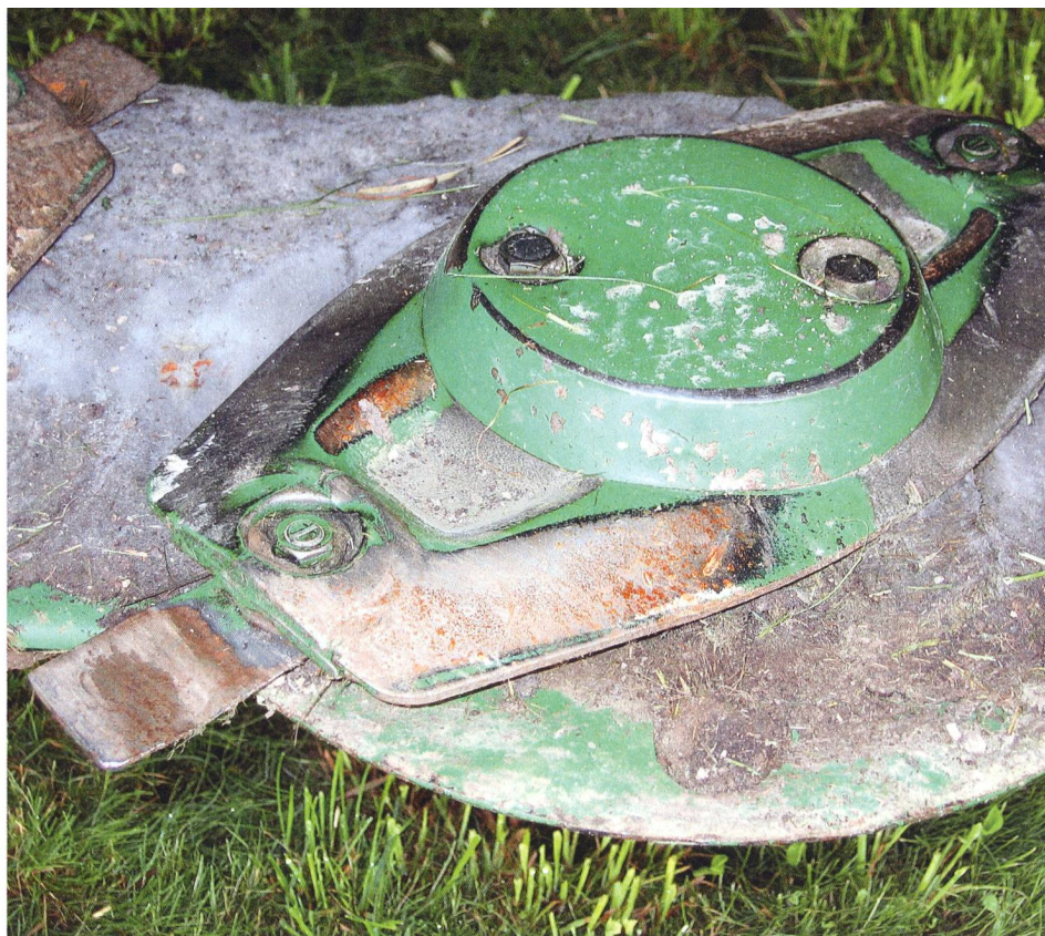
L'herbe mouillée adhérente réduit la durée de vie du lamier.
