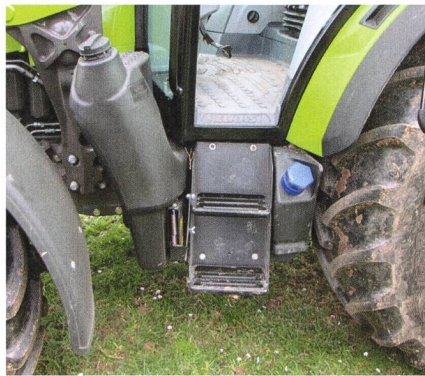
Regroupés à gauche, on trouve l'escalier d'accès, le réservoir de carburant, celui d'AdBlue (bouchon bleu) et une cale.
