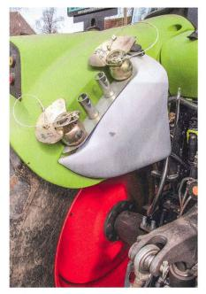
Le réservoir de lave-glace est facile à atteindre et accueille sur le dessus quatre supports pour des rotules de relevage.
