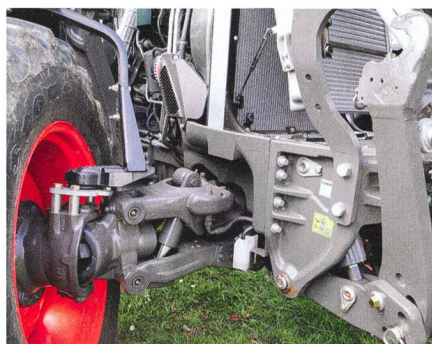
Vue sur le châssis avant, présentant sa «taille de guêpe», et sur la suspension antérieure.
