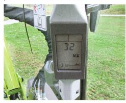
Le montant droit de la cabine accueille un écran secondaire indiquant les principaux paramètres concernant la transmission, à l'instar des rapports présélectionnés.
