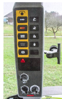
Le montant droit de la cabine accueille un écran secondaire indiquant les principaux paramètres concernant la transmission, à l'instar des rapports présélectionnés.
