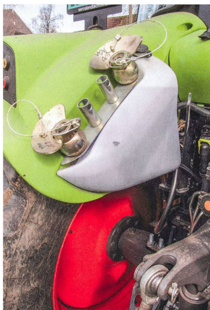
Le réservoir de lave-glace est facile à atteindre et accueille sur le dessus quatre supports pour des rotules de relevage.
