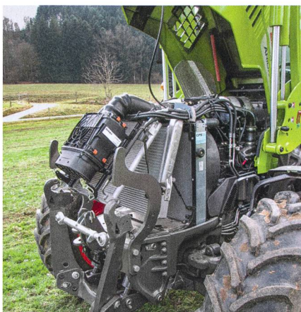
Les différents radiateurs et le filtre à air du moteur sont aisément accessibles une fois le capot ouvert.
