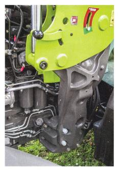
Les attaches pour le chargeur frontal sont directement et solidement fixées sur le carter en fonte.
