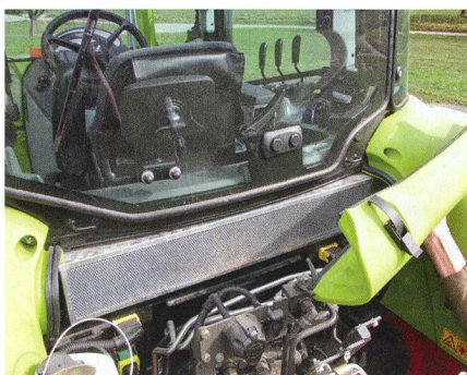
Le filtre à air de la cabine se trouve sous la vitre arrière; même les personnes de petite taille y ont facilement accès.
