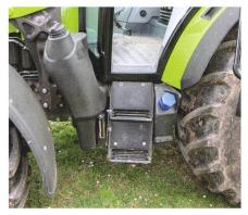
Regroupés à gauche, on trouve l'escalier d'accès, le réservoir de carburant, celui d'AdBlue (bouchon bleu) et une cale.
