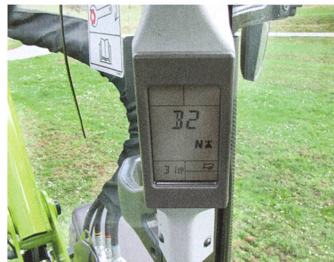
Le montant droit de la cabine accueille un écran secondaire indiquant les principaux paramètres concernant la transmission, à l'instar des rapports présélectionnés.
