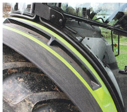
Les ouïes d'aération pour la cabine sont situées sur les ailes arrière.
