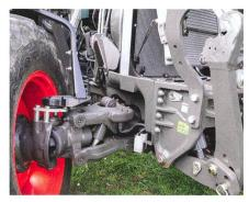
Vue sur le châssis avant, présentant sa « taille de guêpe », et sur la suspension antérieure.
