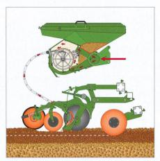
Amazone sépare les graines de manière centrale dans un tambour et les éjecte avec de l'air comprimé dans la conduite jusqu'au soc-semeur. (Photo: Amazone Werkgrafik)
