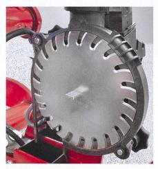
Sur le disque de sélection de Horsch, les graines sont accélérées par la force centrifuge vers les fentes en forme de croissant, puis déposées dans le tube de semis. (Photo: Horsch-Dosierung)
