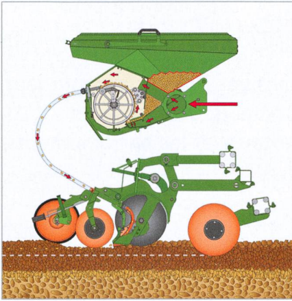
Amazone sépare les graines de manière centrale dans un tambour et les éjecte avec de l'air comprimé dans la conduite jusqu'au soc-semeur. (Photo: Amazone Werkgrafik)
