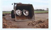
produits Sieplo sont fabriqués en matériaux inox et sont donc insensibles aux sels et aux acides. Leur poids propre est réduit. Une mélangeuse de 1,5 m³ ne pèse que 400 kg à vide.
