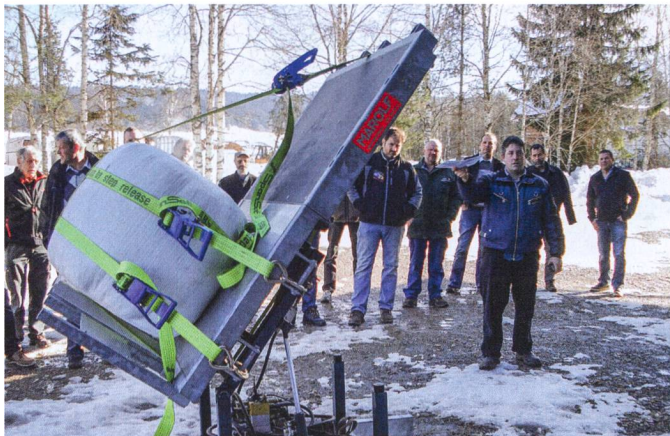
Les participants ont été très intéressés par les exemples pratiques proposés par Dominique Berner lors de sa présentation. Ici, ils constatent les effets du mouvement d'une remorque sur une balle bien arrimée. (Photos: Catherine Schweizer)
