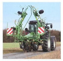
La pirouette dépasse le profil du tracteur et doit donc être munie de bandes d'identification bien visibles, à l'avant aussi. (Photo d'usine)
