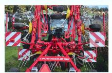
Les outils portés et les remorques de travail dépassant latéralement le véhicule de traction doivent être munis de bandes d'identification à l'avant et à l'arrière.
