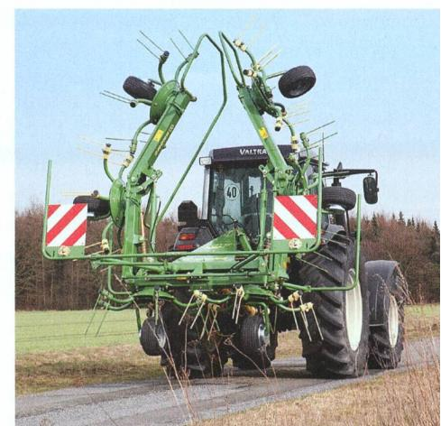
La pirouette dépasse le profil du tracteur et doit donc être munie de bandes d'identification bien visibles, à l'avant aussi. (Photo d'usine)
