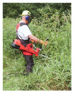
Pour travailler sûrement et ergonomiquement, la débroussailleuse doit être équilibrée et adaptée à la personne. Les équipements de protection individuelle doivent être portés et les distances de sécurité doivent être respectées.
