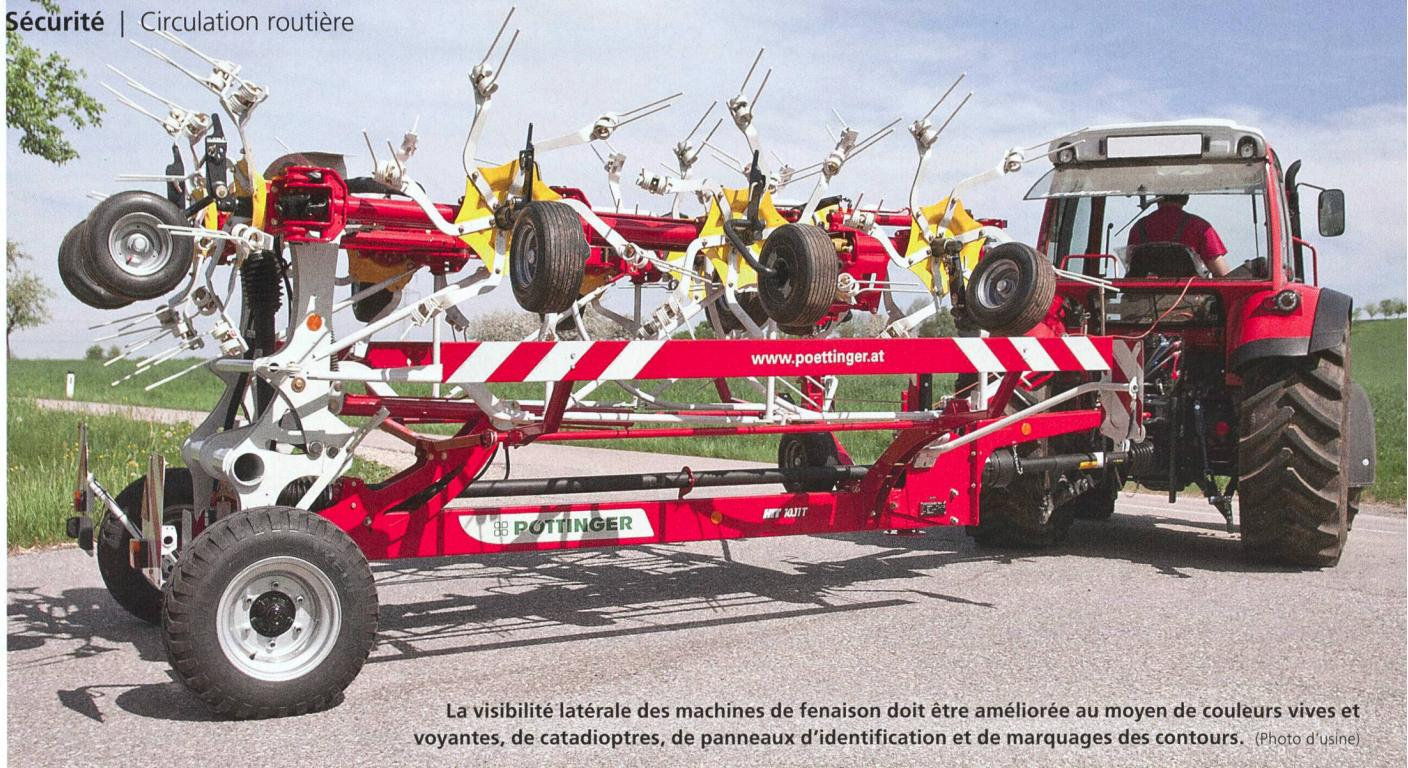
La visibilité latérale des machines de fenaçon doit être améliorée au moyen de couleurs vives et voyantes, de catadioptres, de panneaux d'identification et de marquages des contours. (Photo d'usine)
