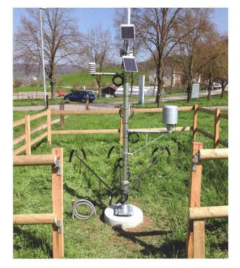
Une station de surveillance du sol comme celle-ci, au centre agricole de Liebegg à Gränichen (AG), mesure les précipitations à 1,5 m du sol, la température et l'hygrométrie aériennes à 2 m, la tension de succion et la température du sol à 20 et 35 cm de profondeur.
