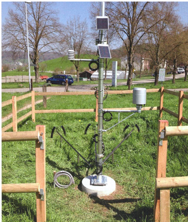
Une station de surveillance du sol comme celle-ci, au centre agricole de Liebegg à Gränichen (AG), mesure les précipitations à 1,5 m du sol, la température et l'hygrométrie aériennes à 2 m, la tension de succion et la température du sol à 20 et 35 cm de profondeur.
