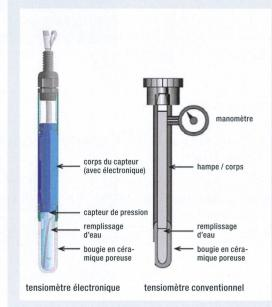
20 cm pour le sol). Dans un sol sec, l'eau contenue dans la bougie en céramique sourd vers le sol par capillarité, en créant une dépression à l'intérieur du tube. Quand le sol entourant la bougie s'assèche, l'eau de l'intérieur de la bougie s'écoule dans le sol. L'eau est ainsi
