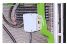
Boîtiers additionnels: une méthode controversée pour augmenter la puissance des moteurs. (Photo: Agroscope)
