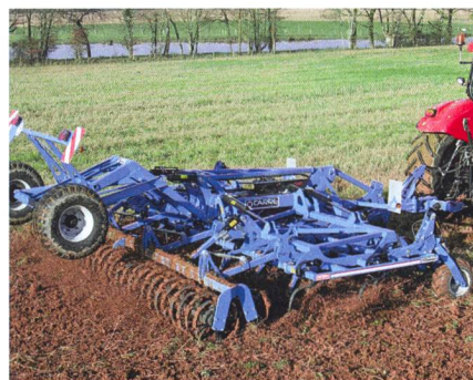
En plus des sarcluses, Carré produit des machines pour le travail superficiel et profond du sol, ainsi que des combinaisons avec des semoirs pneumatiques.
