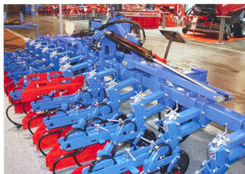
Les éléments de binage standard sont modulables et conviennent aux cultures en lignes de 45 à 80 cm comme le maïs, le soja, les tournesols, etc. (Photos d'usine)
