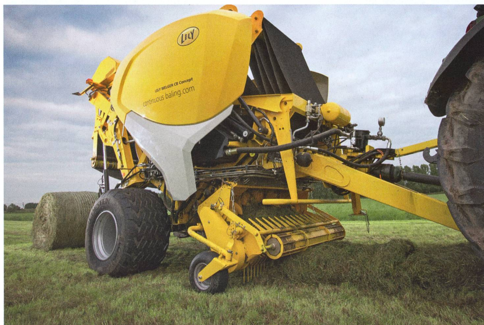
Dans la CB Concept, la « chambre de pressage » supplémentaire est formée dans la courroie unique de plus de 20m de long.
