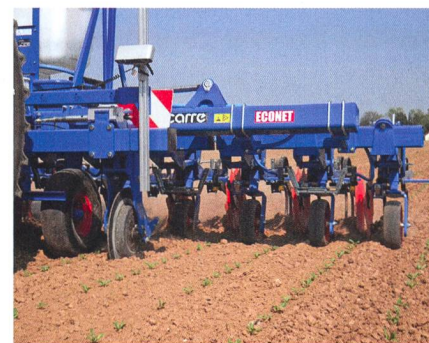
Une caméra à double optique suit les lignes de culture et guide les outils de binage avec la plus grande précision.
