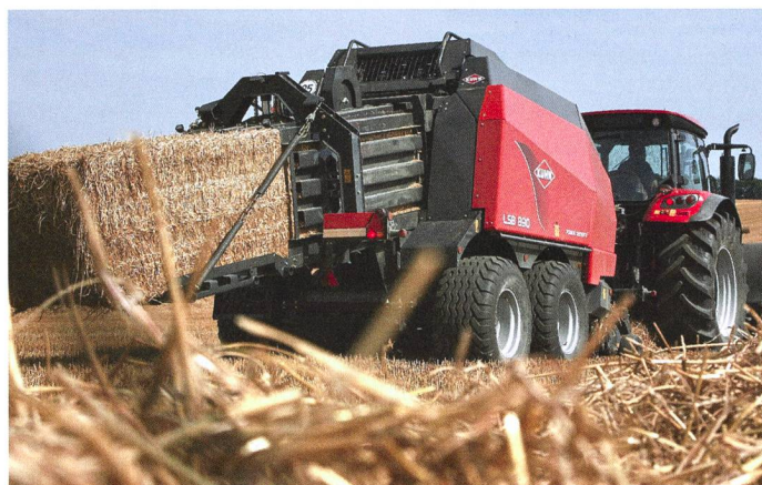
Kuhn a révisé le système d'alimentation de la LSB 890D. Cette dernière dispose désormais d'un pickup de 2300 mm de large, disponible avec des roues de jauge rigides ou pivotantes. (Photo d'usine)
