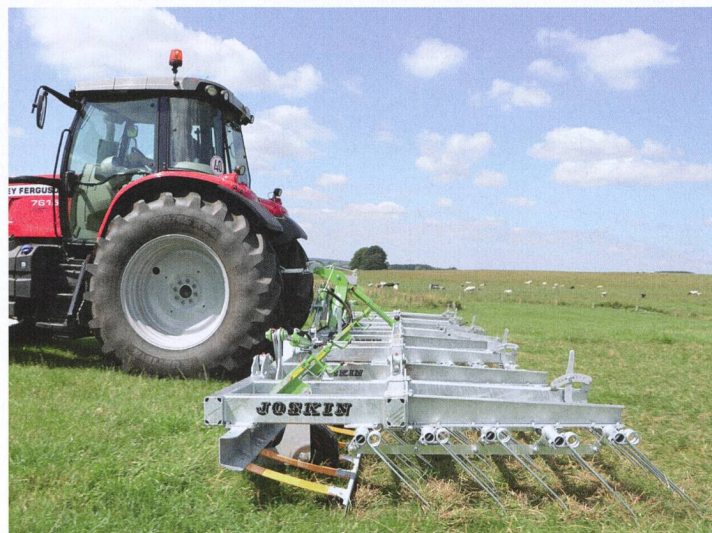
L'aérateur de Joskin peut mettre en œuvre ses forces dans les prairies feutrées. (Photo d'usine)
