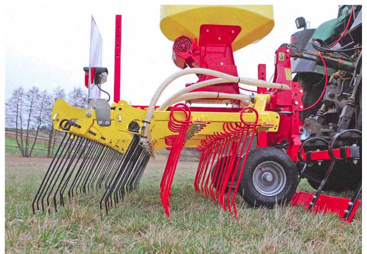
APV dispose dans son assortiment d'un dispositif à dents pour les soins aux prairies qui peut être équipé en option d'un semoir. (Photo d'usine)
