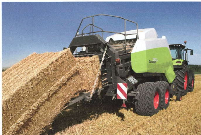
Pour la saison 2015, Claas annonce une nouvelle presse à balles carrées avec 15 % de débit de pressage supplémentaire et 10 % de densité de plus. (Photo d'usine)
