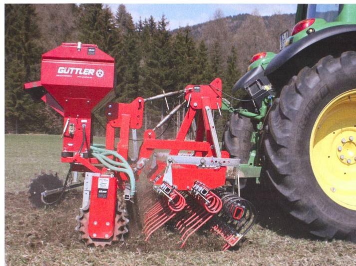
Le rouleau Güttler et la herse de prairie peuvent être combinés et complétés par un semoir. (Photo d'usine)
