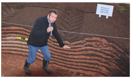
La profondeur des ornières produites par les pneus du tracteur et leur impact sur la compaction du sol sont matérialisés par la déformation permanente des couches de terre de couleur alternée, ce qui permet de les mesurer.
