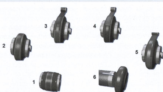
Les étapes de la fabrication de l'ébauche: début (1) et fin (2) de la conformation, pose de la première nappe de ceinture (3) et d'autres nappes (4), pose de la bande de roulement (5), retrait de l'ébauche du tambour.
