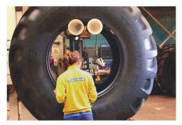
Dans le cadre du contrôle qualité, une collaboratrice effectue des mesures et procède à un contrôle visuel sur le pneu en rotation.
