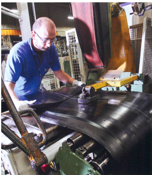
La nappe carcasse est découpée à la longueur correspondant à la circonférence du pneu, puis collée.
