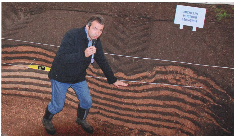
La profondeur des ornières produites par les pneus du tracteur et leur impact sur la compaction du sol sont matérialisés par la déformation permanente des couches de terre de couleur alternée, ce qui permet de les mesurer.
