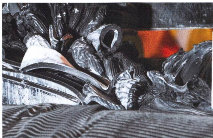
Le mélange des gommés (dont la composition est tenue secrète) est malaxé dans des calandres, puis convoyé jusqu'aux rouleaux de préchauffage.
