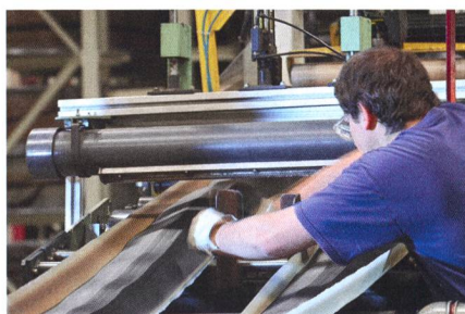
Fabriquées séparément, les bandes de gomme profilées destinées à recevoir les tringles sont placées sur un convoyeur en attendant d'être posées sur la nappe carcasse.
