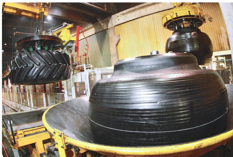
Pneus de tracteurs avant et après conformation à l'usine Michelin de Valladolid (Espagne), où sont fabriqués les pneus destinés aux machines agricoles. (Images communiquées par l'usine/Dominik Senn)
