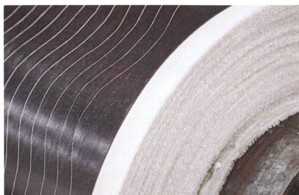
Nappe carcasse en rouleau, formée d'une nappe textile enrobée de caoutchouc.
