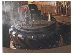
Une fois la cuisson à la vapeur de l'ébauche terminée, le pneu encore fumant est retiré de l'étuve (on entraperçoit en bas le moule qui a permis d'imprimer les sculptures sur le pneu).
