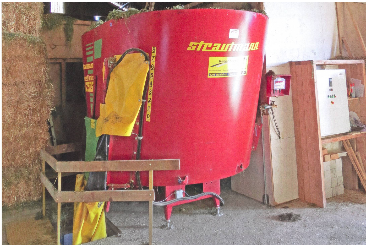
La mélangeuse de fourrage de l'exploitation de Martin Abderhalden est compacte et idéalement positionnée. Le véhicule de distribution est alimenté par la sortie directement au-dessus du dévaloir (à gauche). Le capteur du poussoir est protégé par le plastique jaune.
