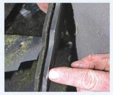
Un aiguisage propre, sans surchauffe, est une nécessité. Le doigt montre un endroit émoussé. On distingue à l'arrière la lame de remplacement (affûtée).
