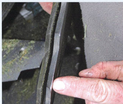
Un aiguisage propre, sans surchauffe, est une nécessité. Le doigt montre un endroit émoussé. On distingue à l'arrière la lame de remplacement (affûtée).
