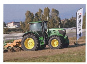
Le véhicule patine peu: en roulant plus vite et en utilisant au mieux le couple disponible, le tracteur effectue le travail plus rapidement et en consommant moins. Bridgestone a conclu un partenariat avec John Deere pour la fourniture de pneus de première monte.
