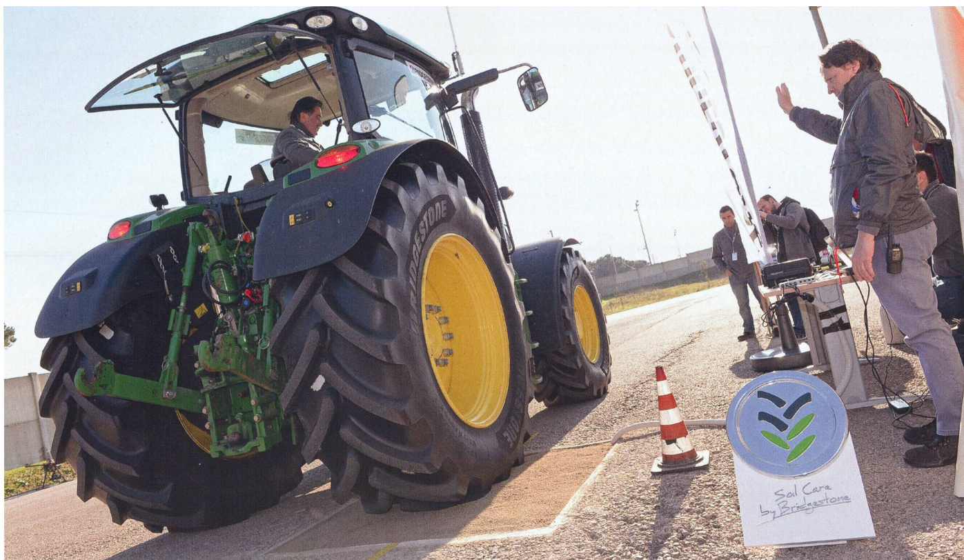
Le VT-Tractor marque le sable de sa très grande empreinte qui est mesurée des capteurs sous terrain. (Photos d'usine)
