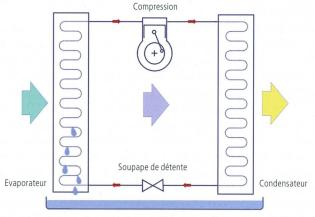
Fig. 17: Schéma d'un déshumidificateur (flux d'air cf. flèche).
