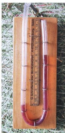
Fig. 23: Mesure de la pression statique. Une extrémité du tuyau est placée sous la grille de la cellule; 1 mm de colonne d'eau correspond env. à 10 Pa.
