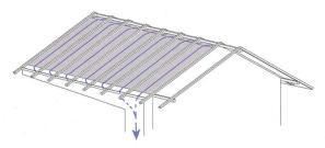
Fig. 9: Capteur solaire (aspiration par la toiture) pour toit à chevrons avec canal collecteur côté gouttière.
