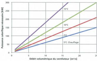
Fig. 16: Puissance calorifique nécessaire en cas de mauvais de temps.
