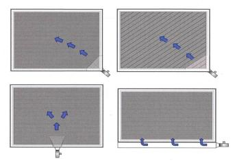
Fig. 2: Position du canal de soufflage, en haut dans le coin, mais avec une disposition différente des supports de la claie, en bas au centre, resp. avec canal de soufflage latéral.
