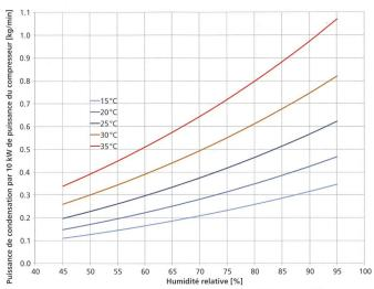
Fig. 18: Puissance de condensation des déshumidificateurs en fonction de la température et de l'humidité de l'air.
