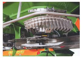
Le limiteur d'épandage à commande électrique peut être contrôlé avec une grande précision lorsqu'il est inséré dans le flux d'épandage.
