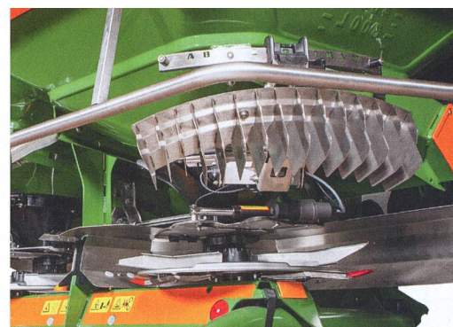
Le limiteur d'épandage à commande électrique peut être contrôlé avec une grande précision lorsqu'il est inséré dans le flux d'épandage.
