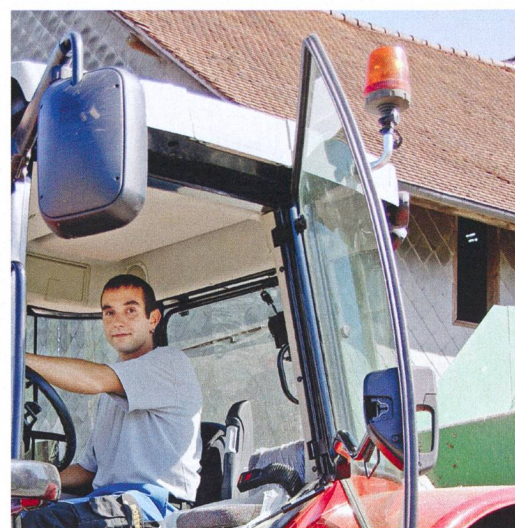
Les feux de danger orange (aussi appelés gyrophares) doivent être mentionnés dans le permis de circulation. Ils peuvent être utilisés lorsque des outils d'une largeur supérieure à 3 m sont attelés ou pendant le service hivernal.
