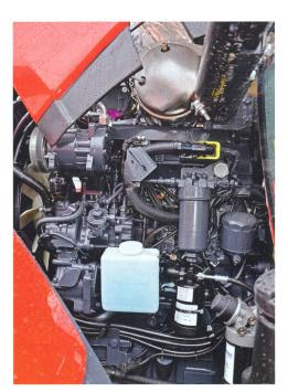
Le moteur IIIB est équipé directement par Perkins d'un filtre à particules.
