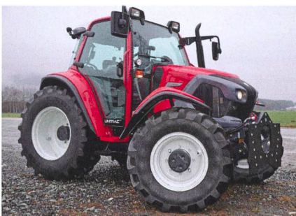
La marche «en crabe» est inspirée par celle des faucheuses à deux essieux.
