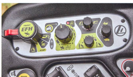
L'EFH (du relevage hydraulique frontal) se commande facilement, de manière analogue à l'EHR, grâce à des symboles explicites.
