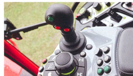
LDrive : la molette de commande s'active par simple pression. La vitesse augmente ou diminue par rotation. Les fonctions quatre roues motrices et blocage de différentiel se situent derrière la molette.
