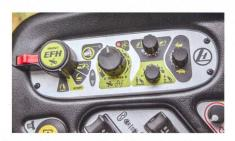
L'EFH (du relevage hydraulique frontal) se commande facilement, de manière analogue à l'EHR, grâce à des symboles explicites.
