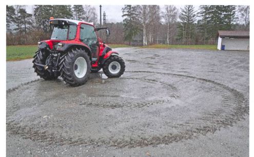
L'essieu arrière directeur permet de réduire le diamètre de braquage de près de 2 mètres.
