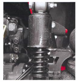
La cabine est montée sur un système à ressorts qui, avec le siège pneumatique, absorbe les chocs et les vibrations.
