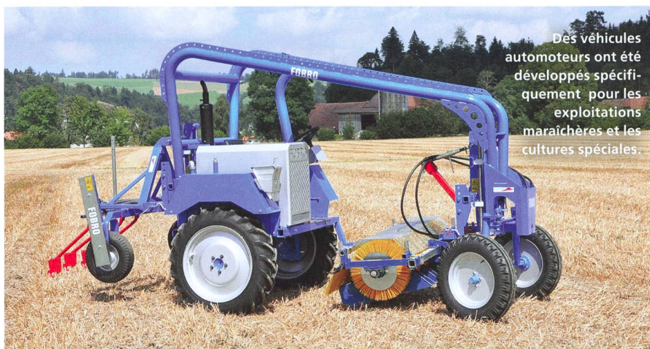
Les sarcleuses à socs peuvent être équipées de différents outils, disques déflecteurs compris.
