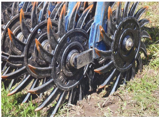
Les outils de la sarcluse rotative arrachent les adventices ou les ensevelissent.
