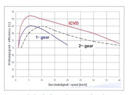
La transmission hydrostatique grand angle (rouge) permet un rendement supérieur à celui de l'hydrostat classique, quelle que soit la vitesse (bleu: plage de vitesses 1/noir: plage de vitesses 2).
