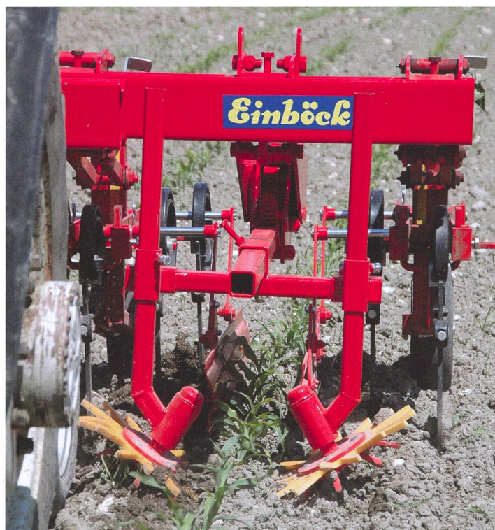
Les sarcleuses à doigts interviennent directement dans la ligne et arrachent les adventices jusqu'au stade 2-feuilles.
