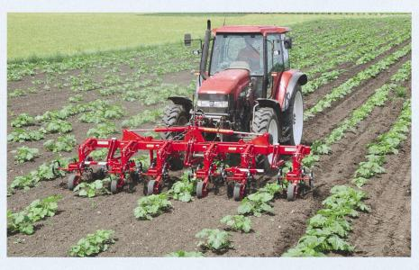
A gauche: l'étrille rotative à entraînement passif est une alternative aux herses étrilles classiques.
