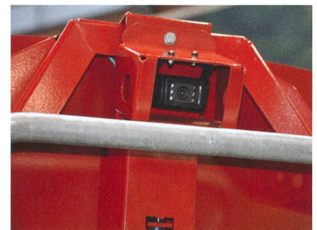
De nombreuses mélangeuses – malheureusement pas toutes – sont équipées de caméra de recul.
