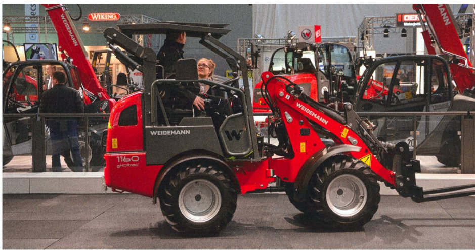
Weidemann et Thaler ont tous deux trouvé une solution pour abaisser le toit de leur chargeur compact. Weidemann propose un toit repliable hydrauliquement, tandis que Thaler abaisse le sien par quatre vérins hydrauliques. Les deux systèmes sont à commande bi-manuelle. (Photos: SPAA)
