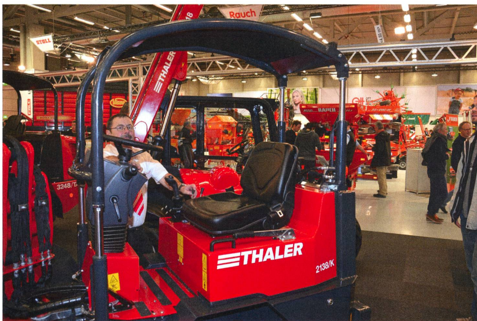
Weidemann et Thaler ont tous deux trouvé une solution pour abaisser le toit de leur chargeur compact. Weidemann propose un toit repliable hydrauliquement, tandis que Thaler abaisse le sien par quatre vérins hydrauliques. Les deux systèmes sont à commande bi-manuelle. (Photos: SPAA)
