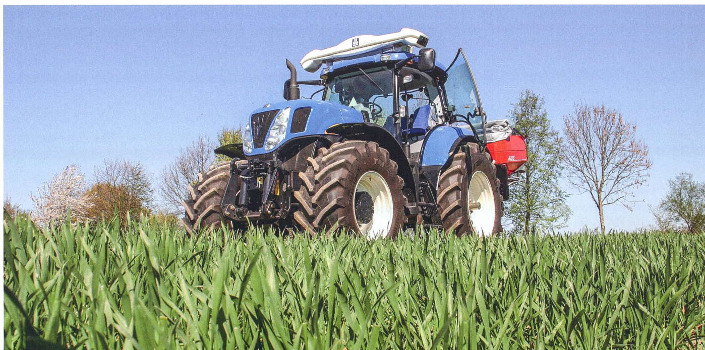
Les systèmes de capteurs n'analysent qu'une partie de la largeur de travail d'un épandeur à engrais moderne. (Photo: Yara)
