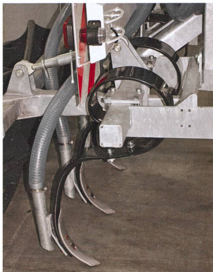
Injecteur pour terres ouvertes, avec ressorts plats et dépôt du lisier directement derrière la dent. La fermeture de la raie et le plombage sont assurés par un rouleau à claire-voie.
