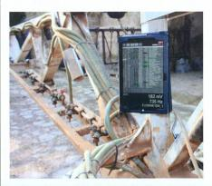
**Système de guidage d'une bineuse** Le système « Agrogeovisio » associe un guidage par vision et par GPS centimétrique pour le pilotage d'une bineuse en toutes situations de culture. La bineuse est guidée dans le rang grâce à un trois-points intermédiaire. Ce guidage peut être réalisé soit par visionique, soit par GPS centimétrique en fonction de l'état de couverture de la culture. Un système de recueil de données enregistre en per-
