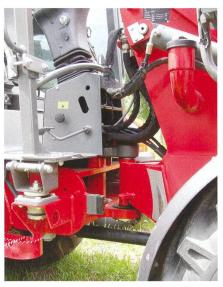
Les chargeurs aux essieux rigides disposent généralement d'une direction articulée oscillante. Lorsque l'articulation est rigide, c'est généralement l'essieu arrière qui est oscillant.
