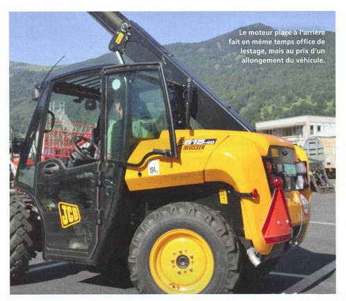
chariot télescopique compact, d'une largeur maximale de 160 cm, et qui dispose d'une transmission hydrostatique à deux gammes de vitesses, à commande de type automobile. Trois modes directionnels sont disponibles.
