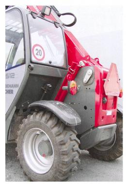
A l'exception du côté droit, le chariot télescopique offre une bonne vision sur le chantier. Le moteur installé sur le côté permet de raccourcir le véhicule, mais nécessite en revanche de renforcer le lestage à l'arrière.
