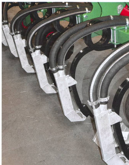
Chez Lomma, la dent et l'injecteur massif se combinent; le lisier est déposé au fond de la raie.
