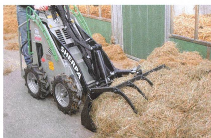
Cette petite chargeuse compacte à entraînement électrique offre juste une «place debout» pour l'opérateur.
