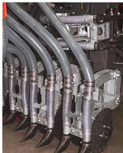
Les bras à guidage parallèle sont reliés au cadre par des barres de torsion en caoutchouc.
