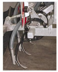
Injecteur pour terres ouvertes, avec ressorts plats et dépôt du lisier directement derrière la dent. La fermeture de la raie et le plombage sont assurés par un rouleau à claire-voie.
