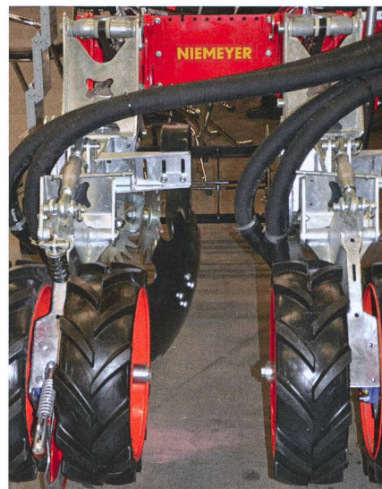
Niemeyer réunit les éléments de son outil pour strip-till avec des injecteurs à double tuyau d'alimentation.
