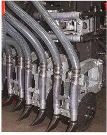
Les bras à guidage parallèle sont reliés au cadre par des barres de torsion en caoutchouc.
