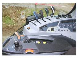
Nouvelle console de commande pour Valtra Active (sans moniteur), avec hydraulique load sensing, assistants hydrauliques et circuits d'huile séparés pour l'hydraulique de travail et la transmission. La transmission permet de choisir entre le mode automatique et le mode manuel pour piloter le tracteur.
