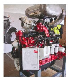
Moteur Diesel AWF de dernière génération, 7,4 litres de cylindrée, produit par Agco Power. La dépollution des gaz d'échappement est entièrement basée sur la technologie RCS avec ajout d'adBlue et catalyseur à oxydation.
