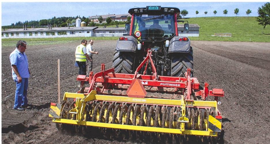
Les participants mesurent le patinage avec une déchaumeuse sur une distance de référence. Constat: la force de traction augmente et le patinage diminue quand la puissance de traction reste constante. (Photos: Dominik Senn)
