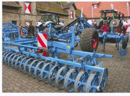
Le Karat 9 offre une qualité irréprochable sur un terrain accidenté avec la régulation de la profondeur de travail Contourtrack. Le report de charge (en option) assure le transfert du poids du cultivateur sur l'essieu arrière du tracteur.
