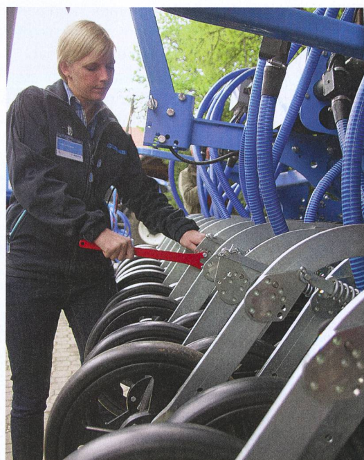
L'intensité de la pression sur les socs à doubles disques de l'OptiDisc M se règle maintenant sur six niveaux.
