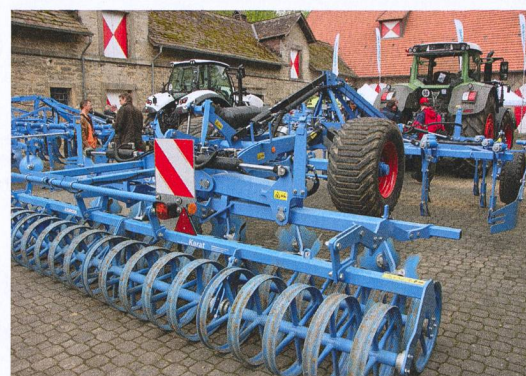
Le Karat 9 offre une qualité irréprochable sur un terrain accidenté avec la régulation de la profondeur de travail Contourtrack. Le report de charge (en option) assure le transfert du poids du cultivateur sur l'essieu arrière du tracteur.
