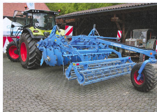
Ce système semi-porté du déchaumeur à disques Rubin avec Unirad ne nécessite pas d'autre dispositif de conduite. Les disques creux crénelés sont disposés de manière antagoniste, ce qui annihile les forces de traction de gauche et de droite.
