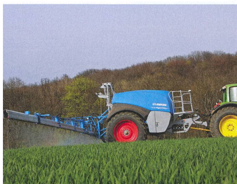
La hauteur de levage des rampes varie de 50 cm à 3 m grâce à la nouvelle combinaison entre le parallélogramme et le mât de levage. (Photo: Lemken)
