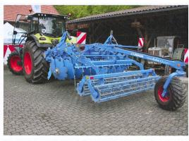
Ce système semi-porté du déchaumeur à disques Rubin avec Unirad ne nécessite pas d'autre dispositif de conduite. Les disques creux crénelés sont disposés de manière antagoniste, ce qui annihile les forces de traction de gauche et de droite.
