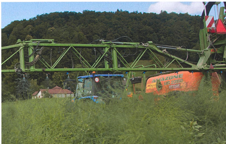
Pendant le transport, l'on voudrait se charger de moins d'eau. Celle-ci doit cependant humidifier la couverture végétale de manière uniforme, bien que des exigences différentes soient posées selon le groupe de pesticides, l'éventail des traitements et la densité de peuplement. (Photo : Ueli Zweifel)
