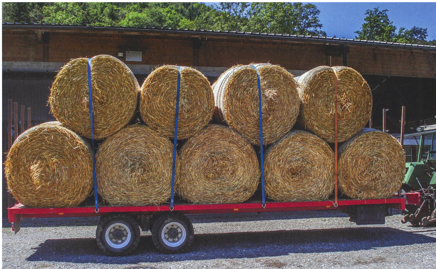
Calage de balles à l'avant et à l'arrière et arrimage à l'aide de sangles. Ne pas oublier de resserrer les sangles après quelques minutes de trajet ! (Photos : ASETA)
