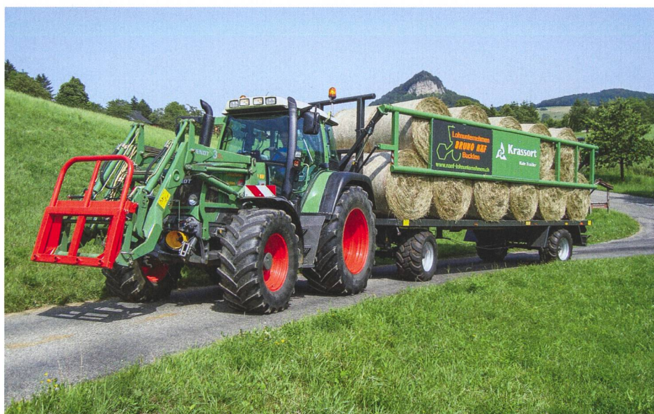
Sécurisation élégante des balles sur la remorque à balles de Krassort : les dispositifs de serrage latéraux à commande hydraulique permettent un calage rapide des balles ou des autres produits à transporter.
