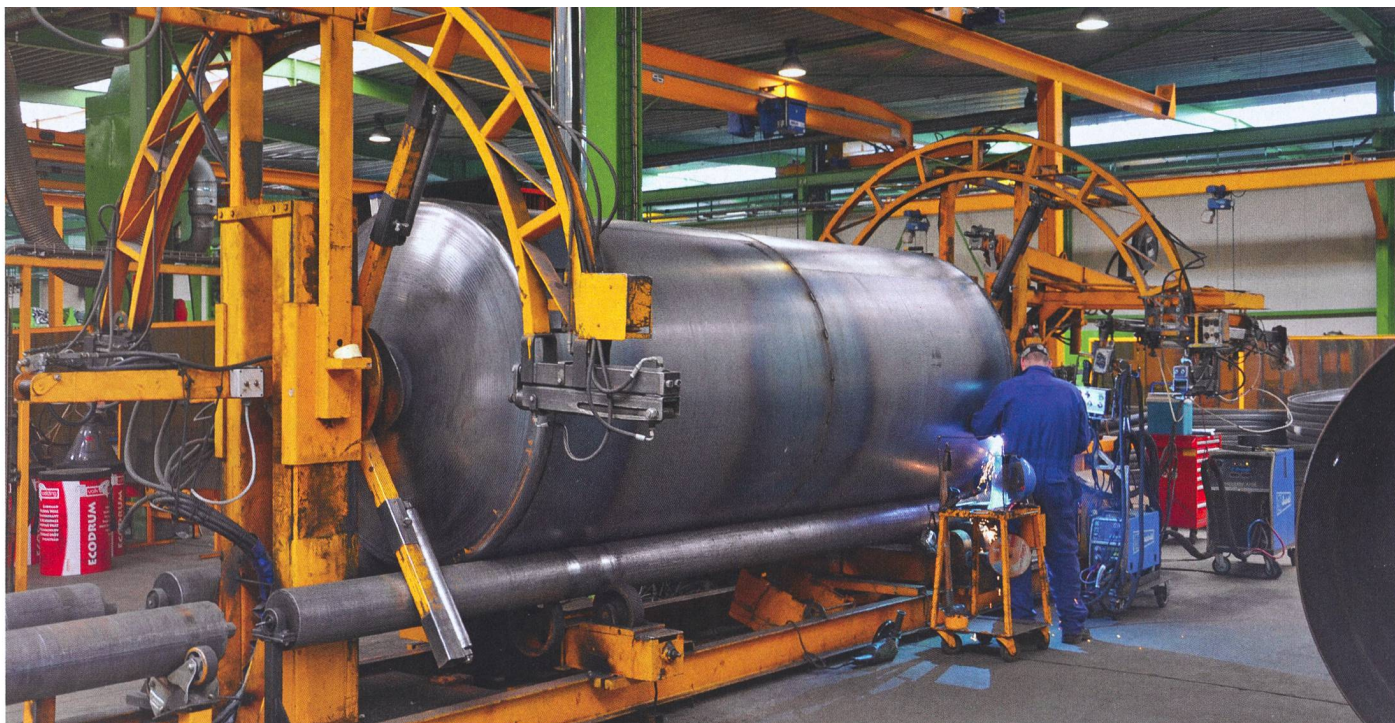
Les tôles sont d'abord cintrées par des presses à commande digitale, puis assemblées aux dimensions voulues par des robots de soudure. Le couvercle et les accessoires restent soudés manuellement. Ensuite, la citerne passe l'étape de la galvanisation à chaud. (Photos d'usine et de Dominik Senn)
