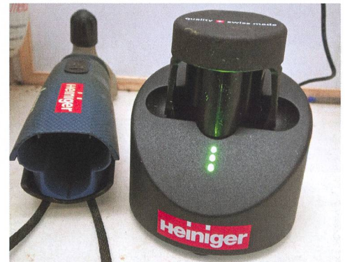
Des indicateurs à LED permettent de voir le niveau de charge de l'accu.
