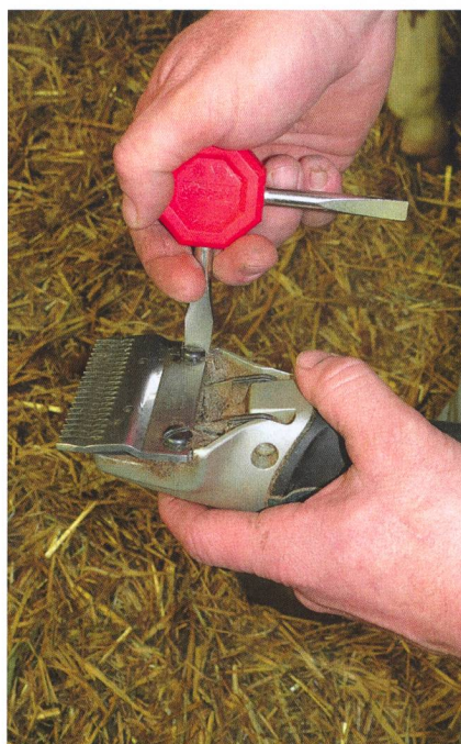
Le changement des deux couteaux se réalise avec un tournevis spécial. On les démonte facilement, en étendant la lame supérieure et en dévissant les deux vis d'un tour.
