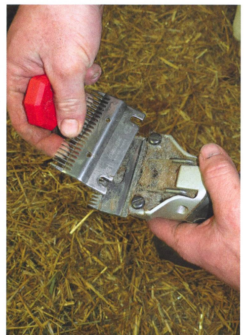
Le changement des deux couteaux se réalise avec un tournevis spécial. On les démonte facilement, en étendant la lame supérieure et en dévissant les deux vis d'un tour.
