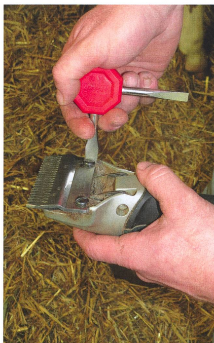
Le changement des deux couteaux se réalise avec un tournevis spécial. On les démonte facilement, en étendant la lame supérieure et en dévissant les deux vis d'un tour.
