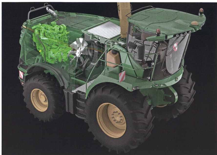
Les unités de refroidissement regroupées au milieu de la machine, le moteur peut être monté en long, très en arrière de la machine; sa masse permet de réduire celle du contrepoids éventuel.
