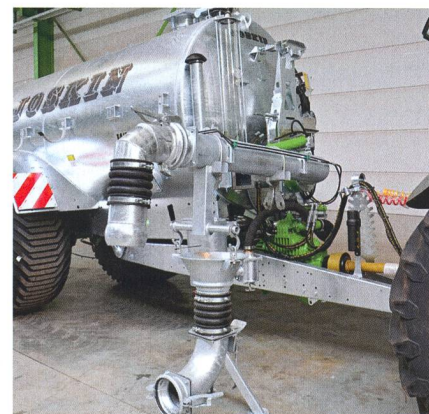
Le bras de pompage est abaissé jusqu'à se poser sur le sol. Maintenant, la position peut être définie avant l'aspiration.
