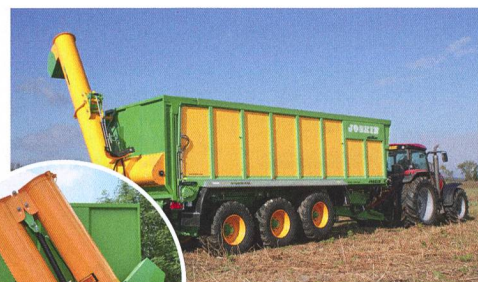
Vis de transbordement de la remorque à fond roulant prête à l'emploi ... et en position transport.
