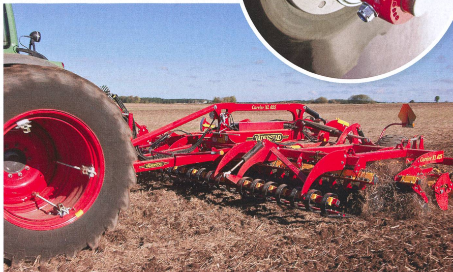
Les nouveaux Carrier L et XL gèrent des volumes conséquents de substances organiques. Leurs disques de 51 cm et 61 cm de diamètre pouvant être intervertis. Illustration circulaire: cette élégante construction MultiSet permet de régler l'angle d'attaque des disques aisément en quelques manipulations.
