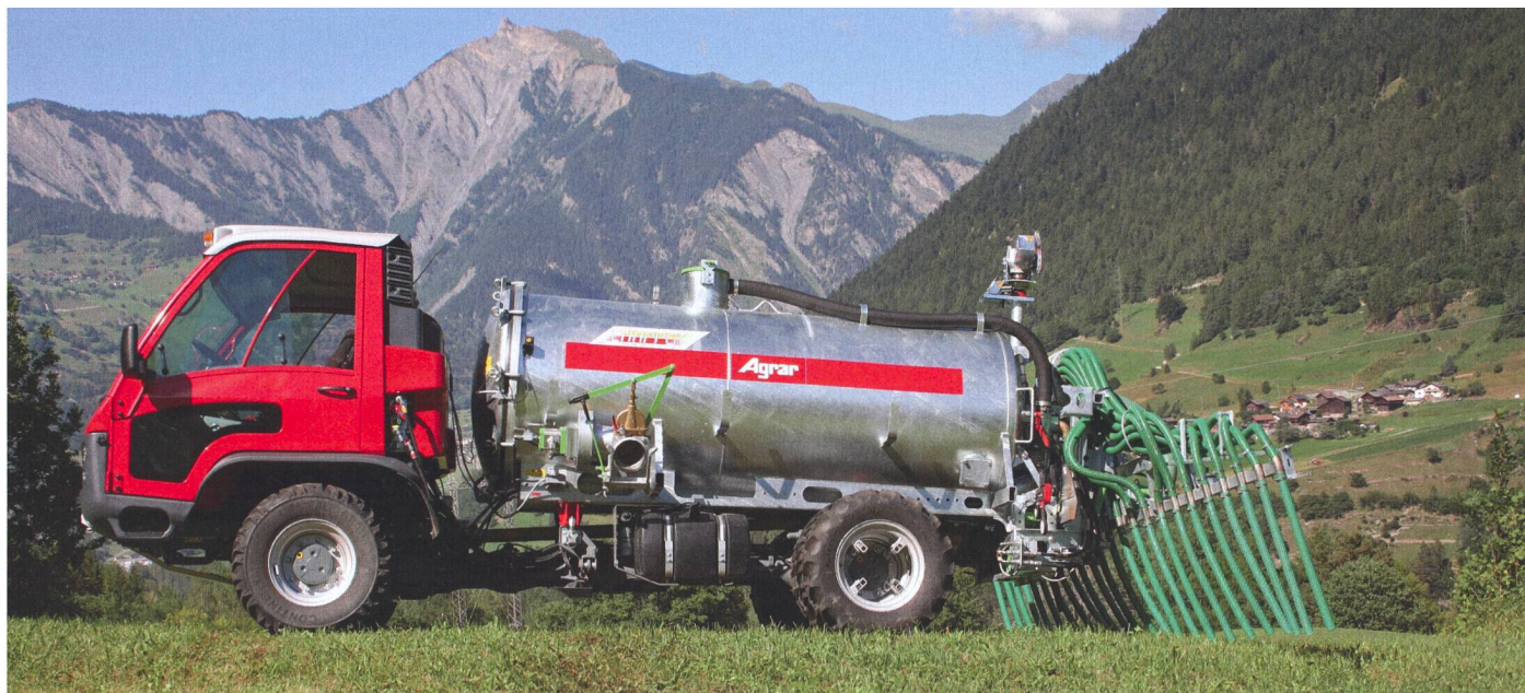
Les citernes portées actuelles peuvent être équipées d'une rampe à pendillards pour réduire les émissions. (Photos d'usine)
