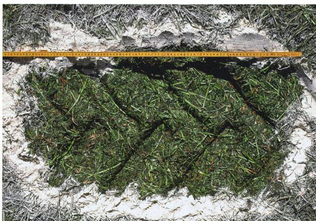
La surface de contact des roues au sol dans le silo a été relevée grâce à un marquage à la chaux et à une détermination photogrammétrique de la surface a posteriori.
