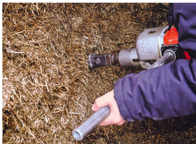
La détermination des compacités grâce à des carottes prélevées par sondage a montré que les densités étaient très hétérogènes dans les silos.
