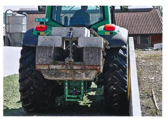
Tracteur de compactage avec pneus de différentes largeurs.
