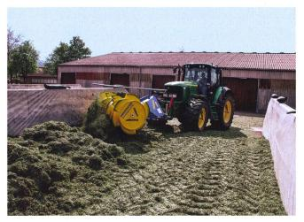
Les distributeurs d'ensilage permettent une répartition régulière du fourrage, ce qui est une condition essentielle pour obtenir un fourrage de qualité.
