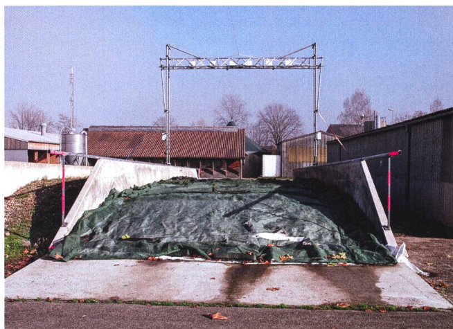
Ce silo-couloir de 6 m de large et de 26,5 m de long a servi aux essais. En haut sur la photo, on distingue le pont de mesure à ultrasons qui a servi à déterminer le volume du silo.
