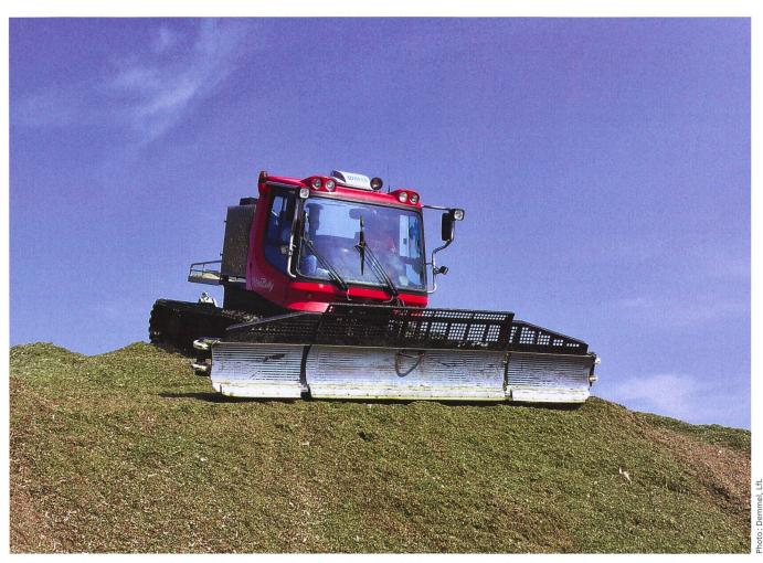
L'utilisation de dameuses permet de répartir l'ensilage rapidement. En dépit de la faible pression à la surface de contact, les expériences réalisées en pratique sont très bonnes, à condition de ne tasser que des couches planes.
