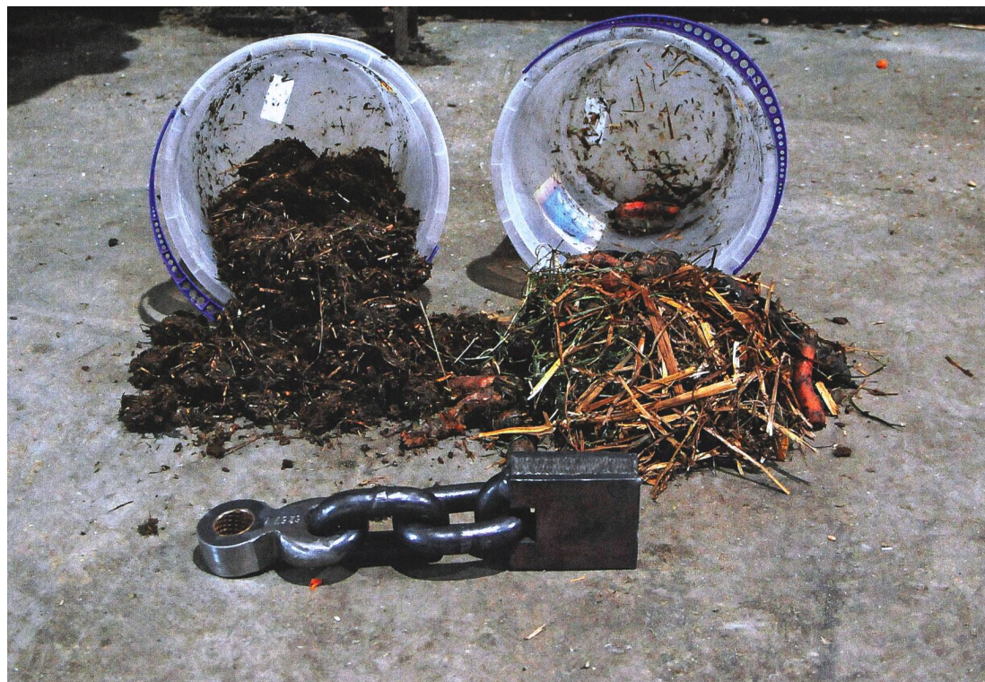
Le matériau ligneux (à d.) est transformé en un mélange homogène et bien fermenté (à g.) par les marteaux en chaîne.
