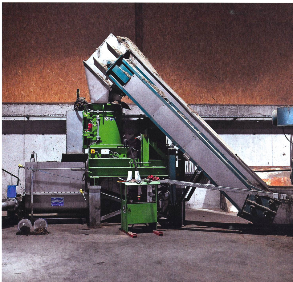
De la trémie de dosage avec balance (à droite), la matière première passe sur un tapis roulant pour se déverser dans le Bio-QZ, puis dans la pompe d'alimentation.
